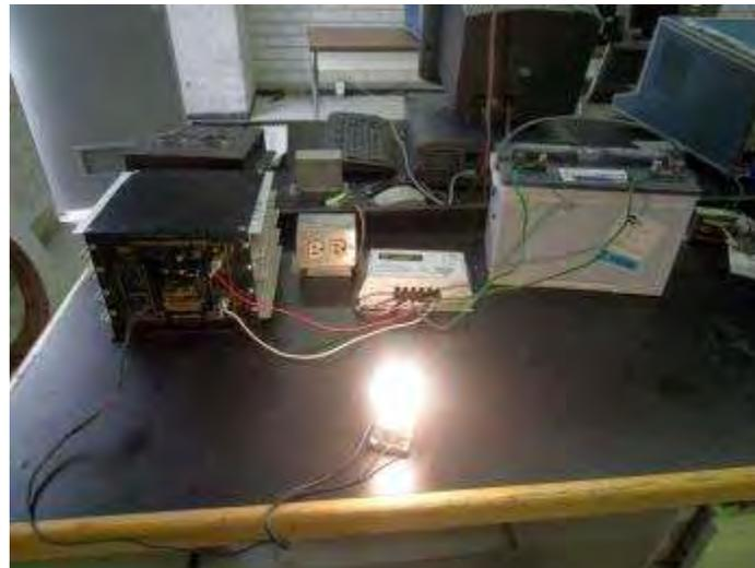
Figura 5.5. Prototipo de generación de energía eléctrica a través de un panel fotovoltaico
