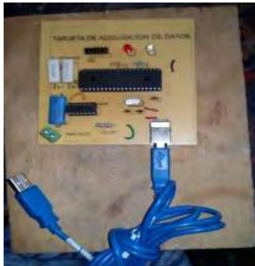
Figura 5.18. Tarjeta de Adquisición de Datos
