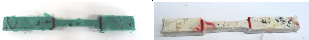
Figura 3.1. Probetas tipo “dog bone” para ensayos de esfuerzo de deformación uniaxial
