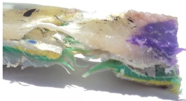
Figura 4.90 Imagen macroscópica de probetas fracturadas HDPE – Tetra Pak multicolor M2
