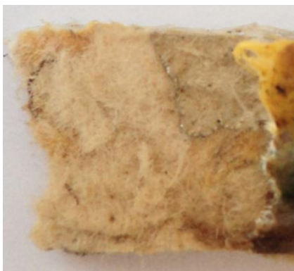
Figura 4.87 Imagen macroscópica de probetas fracturadas HDPE – Tetra Pak multicolor M2
