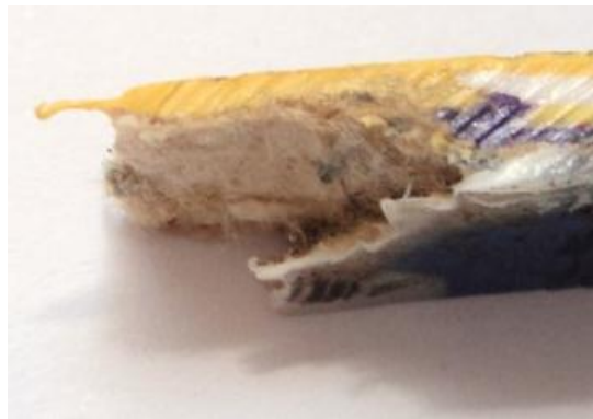
Figura 4.86 Imagen macroscópica de probetas fracturadas HDPE – Tetra Pak multicolor M2
