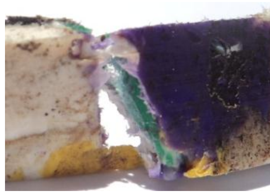
Figura 4.85 Imagen macroscópica de probetas fracturadas HDPE – Tetra Pak multicolor M2
