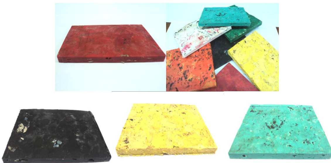
Figura 3.6. Placas moldeadas de HDPE y hojuelas de Tetra Pak.
