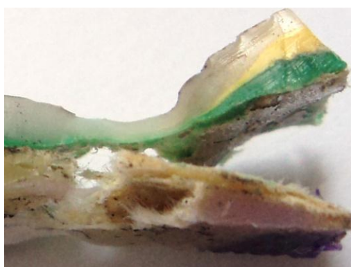
Figura 4.89 Imagen macroscópica de probetas fracturadas HDPE – Tetra Pak multicolor M2
