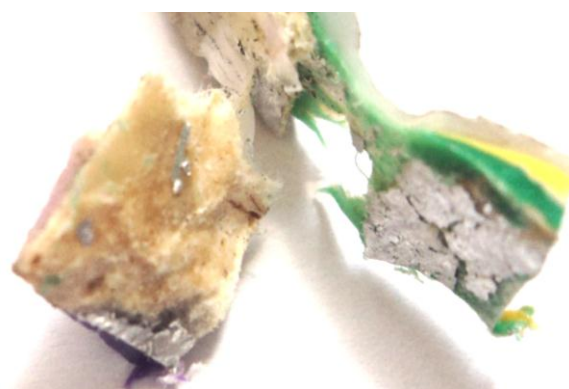
Figura 4.91 Imagen macroscópica de probetas fracturadas HDPE – Tetra Pak multicolor M2
