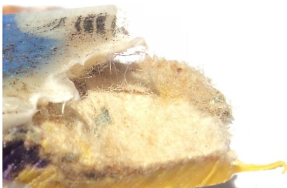
Figura 4.88 Imagen macroscópica de probetas fracturadas HDPE – Tetra Pak multicolor M2
