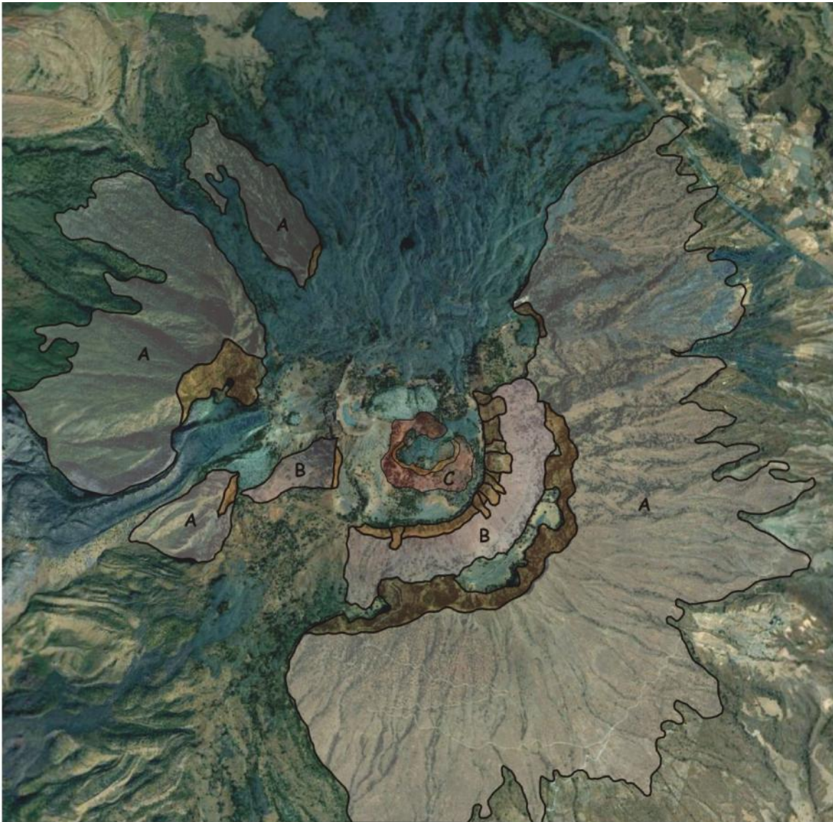
Figura 19. Tres calderas concéntricas que coronan la cima del Ceboruco. A) La primera y más grande, conocida como caldera exterior y la cual data de hace 1 000 años; B) Segunda caldera, denominada como interior o Dos Equis; C) La última y más pequeña, El Centro. Se observan rasgos de destrucción.
