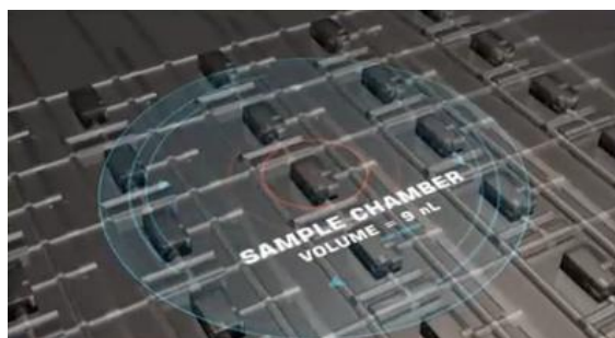
Figura No. 21. Cámaras para muestras con un volumen de 9 nL en un chip del fluidigm.
