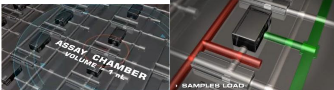
Figura No. 22. Izquierda. Cámaras para el ensayo con un volumen de 1 nL en un chip del fluidigm. Derecha. Mezclado de la muestra con el ensayo en el chip.
