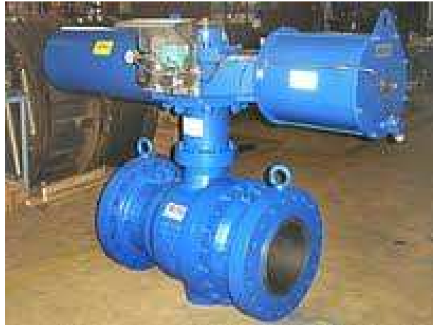
Figura 3.2 Válvula de seccionamiento.
