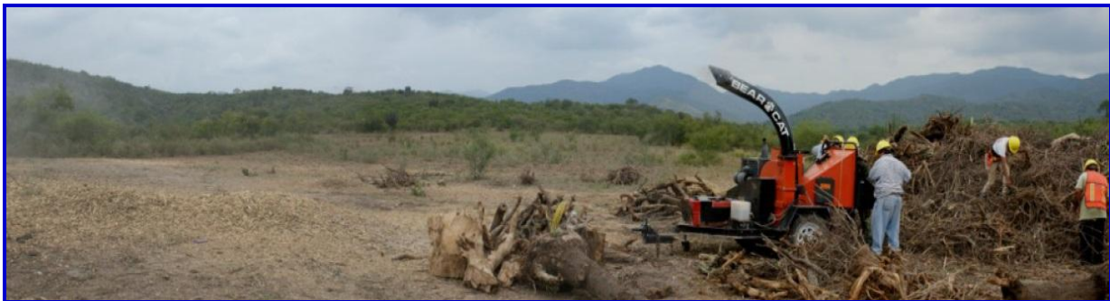
Figura 28. Acumulación y trituración del material vegetal para su posterior reincorporación al suelo
