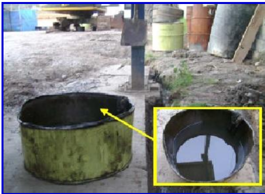
Figura 43. Contenedores para captar el hidrocarburo
