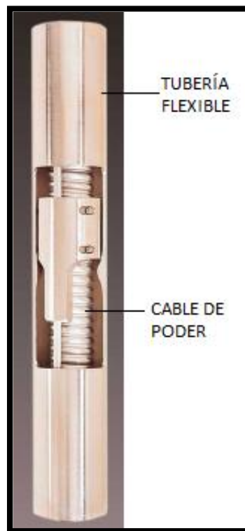
Figura 3.10 BEC bajado con TF con cable interno.
