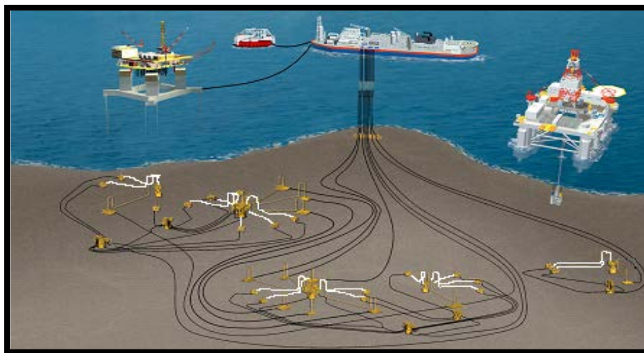
Figura 2.33 Jumpers del Pozo.
