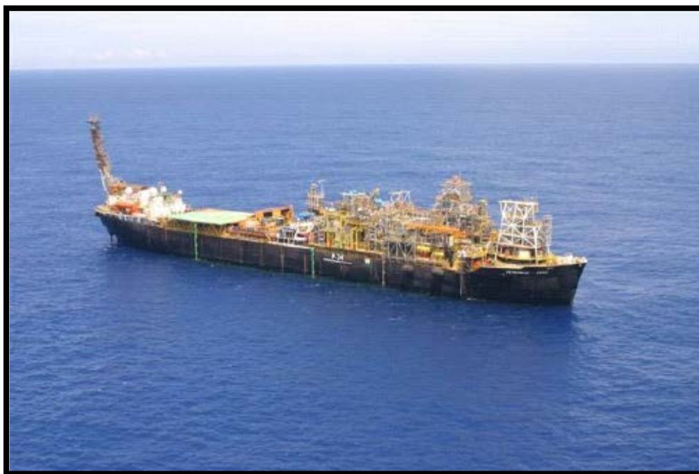
Figura 4.15 FPSO P-34 anclado en la locación.
