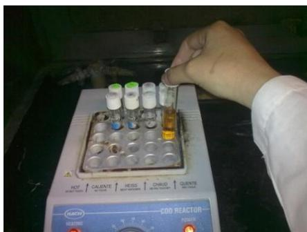
**Figura 41 Colocación en el termoreactor**
