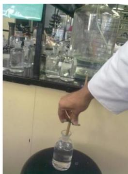
**Figura 32 Rellenado de los frascos Winkler con solución nutritiva para DBO.**
