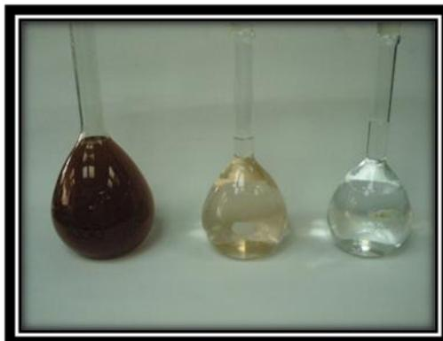
**Figura 30** Muestras realizadas para curva Patrón
