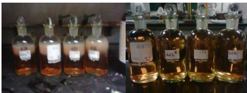
**Figura 37 Adición del ácido sulfúrico concentrado**
