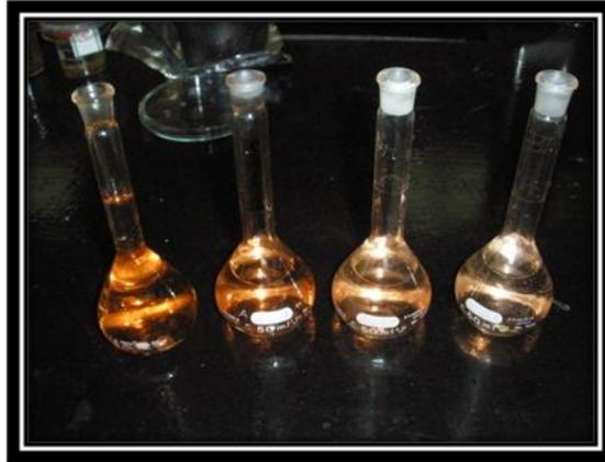
**Figura 29** Coloración de las muestras listas para Medir en espectrofotómetro.
