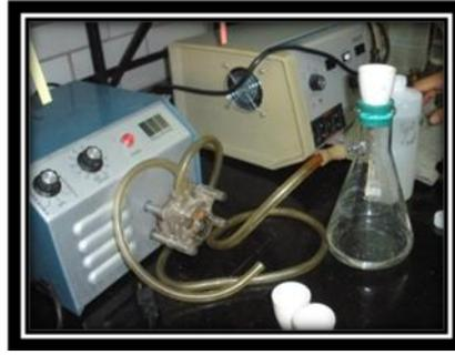
Figura 16 Aplicación de Vacío a crisol Gooch
