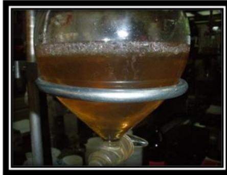
Figura 25 Aparición de fases en embudo de separación
