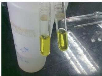
**Figura 40 Adición de soluciones catalíticas a las muestras de Agua Residual.**
