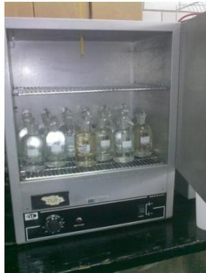
**Figura 34 Introducción de los frascos en la estufa para su incubación**
