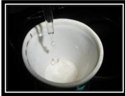
Figura 17 Muestra de agua a crisol Gooch
