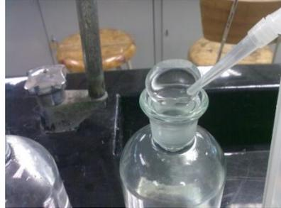
**Figura 33 Colocación del tapón de agua en cada uno de los frascos Winkler**
