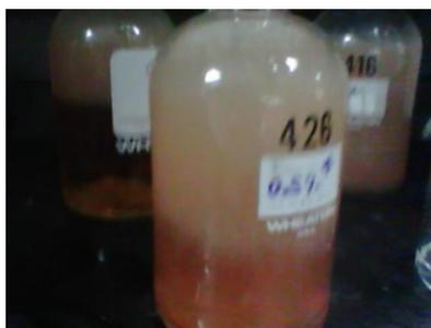
**Figura 36 Adición del álcali-yoduro a cada una de las muestras**
