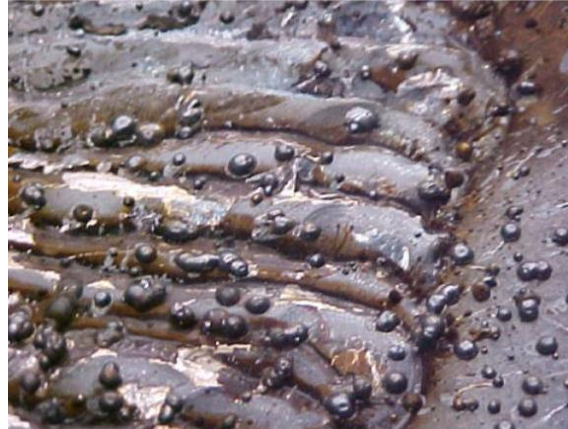
Ilustración 1.8.1.1.5-1 Aspecto de la salpicadura en la soldadura (Rosario Francia, 2012)
