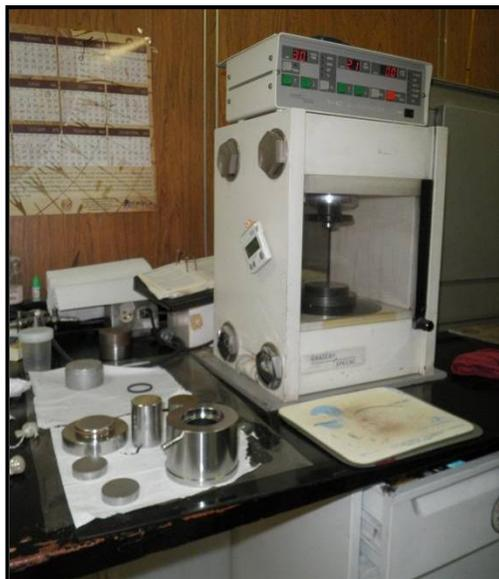
**Figura 4.4** Prensa Grasevy/Specac utilizada en la preparación de las tabletas para la determinación de elementos traza por Fluorescencia de rayos X.
