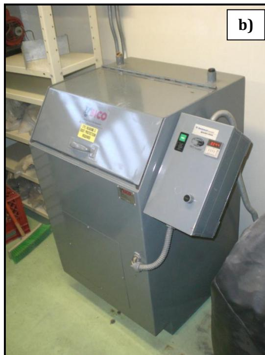
**Figura 4.1** a) Mortero de anillos de acero utilizado en la pulverización de las muestras; b) trituradora marca Bico.
