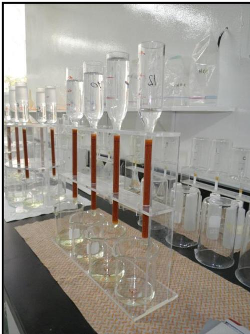
**Figura 4.6** Columnas de intercambio iónico para la separación del estroncio y Tierras Raras.
