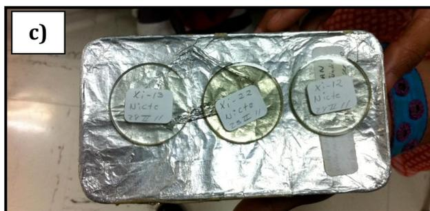
**Figura 4.3** Preparación de las muestras para el análisis de elementos mayores: a) pesado y preparación de la mezcla (muestra +  $\text{Li}_2\text{B}_4\text{O}_7$ - $\text{LiBO}_2$ ); b) hornillo utilizado en la fusión de las perlas y c) perlas etiquetadas y listas para el análisis de elementos mayores por FRX.
