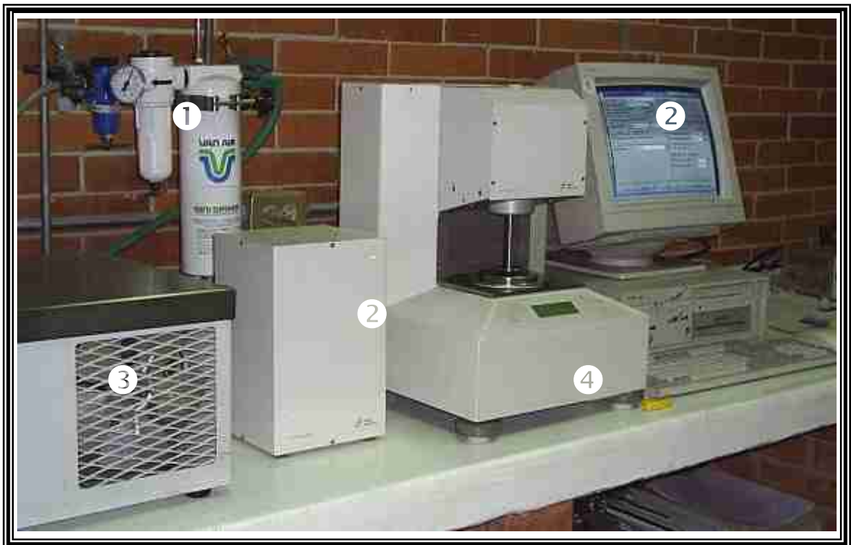
Figura 3.2 Reómetro empleado para la caracterización reológica del Látex. ① Sistema de presión de aire. ② Interfase de comunicación. ③ Sistema de Termostatación. ④ Reómetro.
