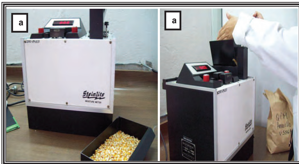
Figura 2.20 a) Equipo Marca Steinlite para determinación de humedad; 2.20 b) Determinación de humedad de una muestra
