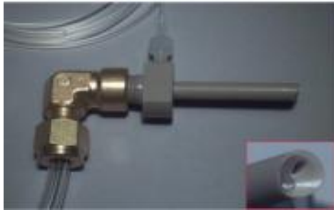
Figura 3.5 Nebulizador tipo Babington
