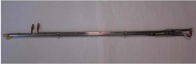
**Ilustración 9. Sonda, tubo de Pitot y termopar**
