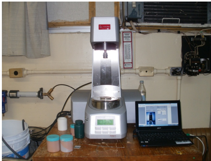
Figura VI.3. Reómetro Physica MCR 101 utilizado para la caracterización reológica de las muestras.
