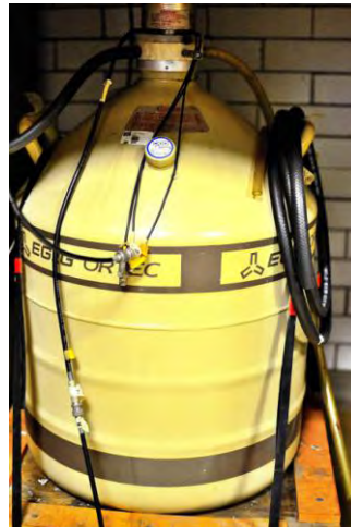
Figura 3.1.1.1 # Criostato. En este recipiente es vaciado el nitrógeno líquido, para enfriar al detector localizado en su interior.
