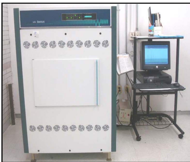
Figura 8. Espectrómetro de Centelleo Líquido (ECL) de ultra bajo nivel Quantulus 1220 utilizado para la determinación de ^{14}\text{C} a partir del benceno sintetizado.
