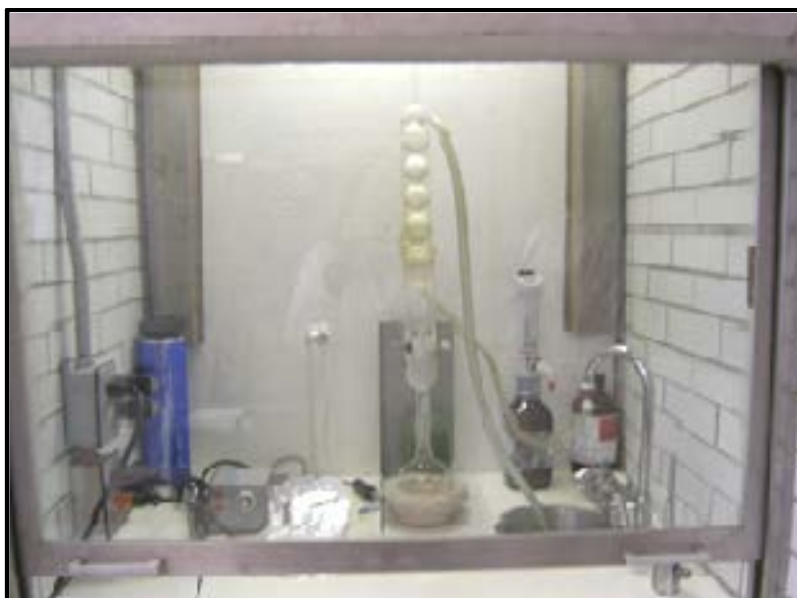
Figura 4. Equipo de extracción Soxhlet bajo campana utilizado para la limpieza de los anillos.
