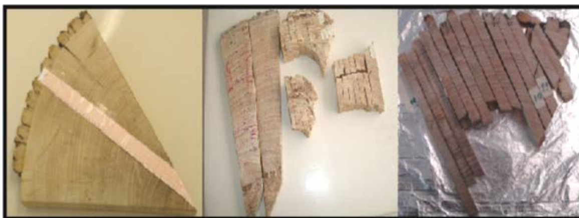
Figura 2. Rodaja de Fresno del lado izquierdo y la segmentación del lado derecho.
