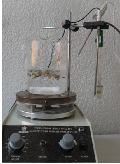
Figura 1.3. Dientes sumergidos en solución desmineralizadora en el agitador magnético.
