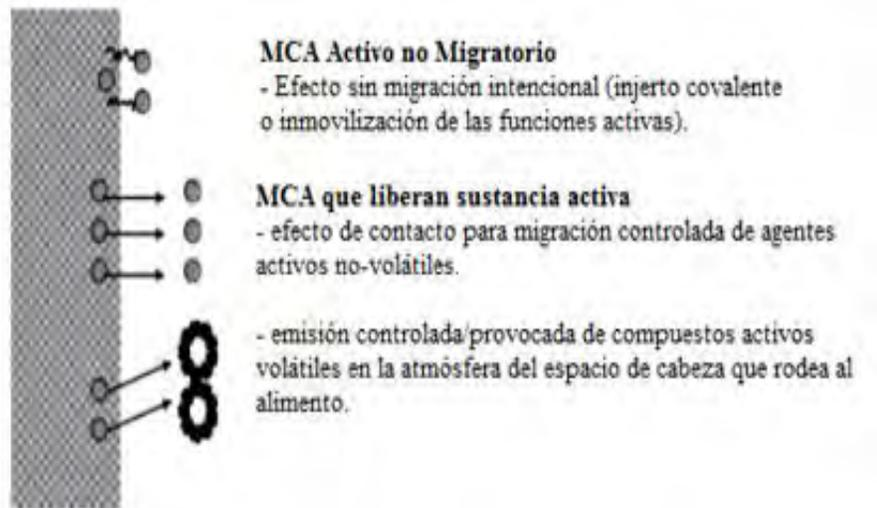
**Fig. 1.5.1. Esquema de los dos diferentes tipos de materiales en contacto con alimento (MCA) clasificados en función de migración intencional o no intencional (Gontard, 2008).**
