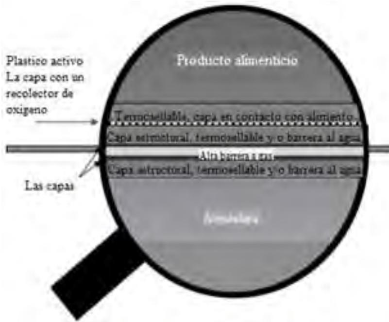
**Fig. 2.2.1.3 Esquema de un sistema ideal que recolecta oxígeno (López-Rubio, 2004)**
