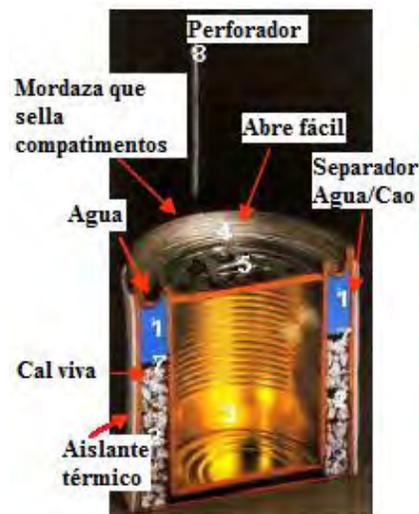
Fig. 2.2.12.1 Sistema de envasado de autocalentamiento (Galet, 2009)
