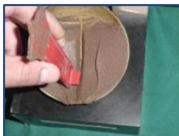
Figura 34. Muestra con exceso de agua [33]
