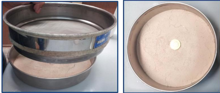
Figura 49. Cribado de la prueba.
