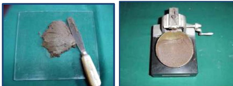
Figura 32. Copa de Casagrande y cuarteo de la muestra [33]
