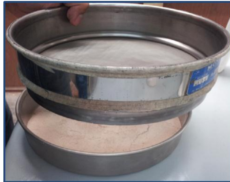
Figura 30. Cribado de la muestra con la #40.
