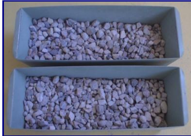
Figura 58. Muestra cuarteada (agregados CEMEX).
