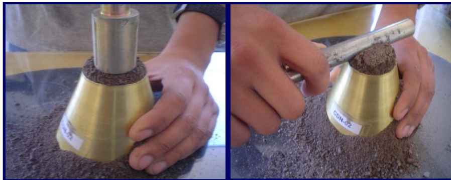
Figura 18. Compactación y enrasado del cono truncado (agregados CEMEX).
