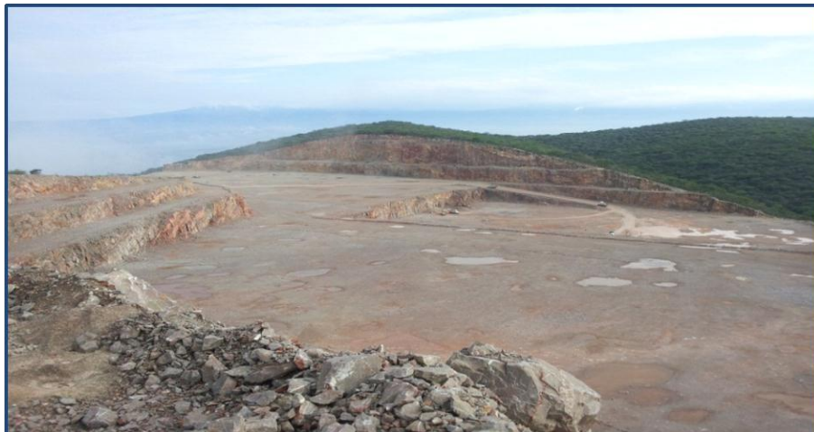
Figura 61. Anticlinal San Lucas, donde se encuentran las canteras de Gramol y Begassa, vistas desde la carretera 57 Nuevo León-Monclova. Cantera de caliza de Cementos Moctezuma unidad Tepetzingo, con varios bancos de trabajo.
