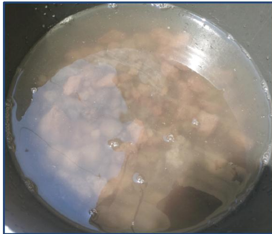
Figura 24. Muestra de grava en saturación por 24 horas
