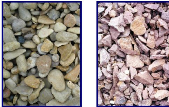
Figura 10. Comparación de la textura de los agregados.
