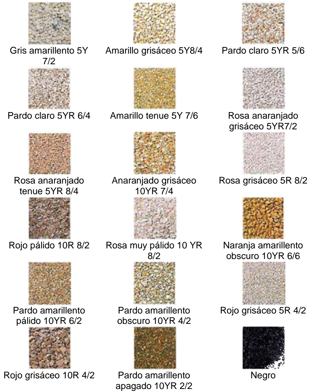
Figura 7. Gama de colores elaborada con información de agregados CEMEX y las tablas de Colores Munsell [7]
