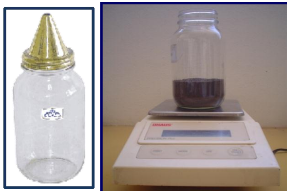
Figura 21. Picnómetro con material en estado SSS [34]
