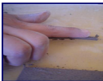
Figura 36. Formación de rollos de plasticidad (agregados CEMEX).
