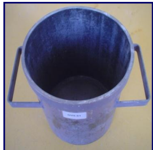
Recipiente cilíndrico para peso volumétrico con factor y tara conocidos con capacidad mínima de 14 litros
