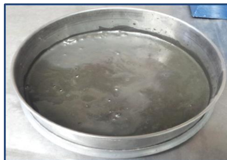
Figura 31. Muestra después de saturarse por 24 horas.
