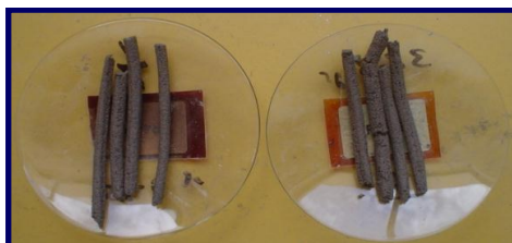
Figura 37. Rollos listos para entrar al horno (agregados CEMEX).
