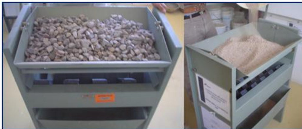
Figura 57. Cuarteado de grava y arena (agregados CEMEX).
