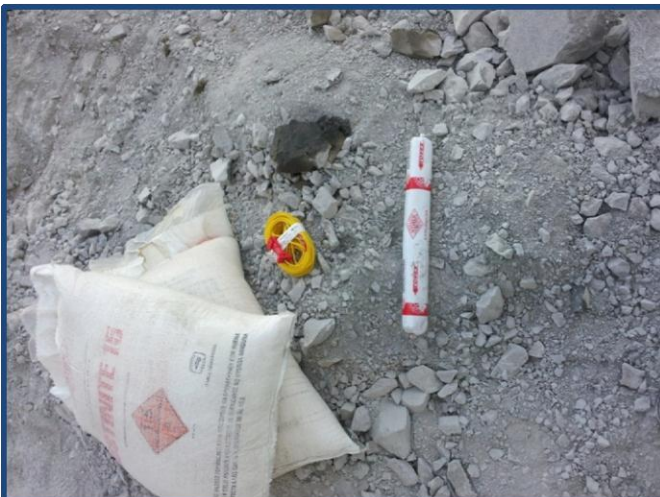
Figura 74. Explosivos comúnmente utilizados en una voladura. Alto explosivo, estopín, tubo de choque, ANFO. (productos de Austin Powder).
