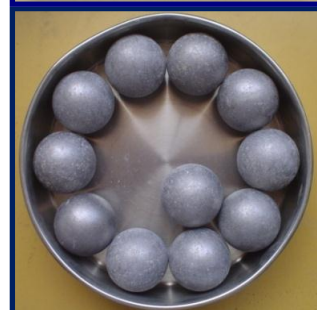
Carga abrasiva. Esferas de acero con un diámetro promedio de 45mm y cada una con una masa entre 390 y 445g
