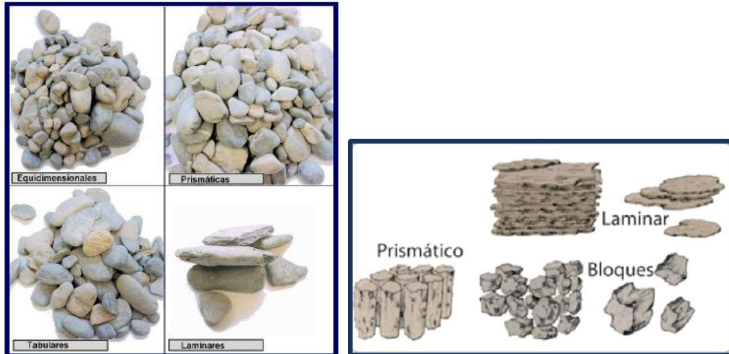
Figura 9. Diferentes formas de los agregados [32]
