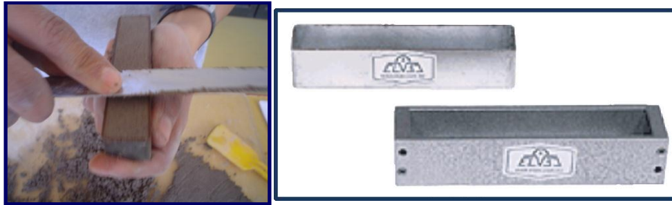
Figura 38. Llenado de los moldes de contracción lineal con material sobrante [34]
