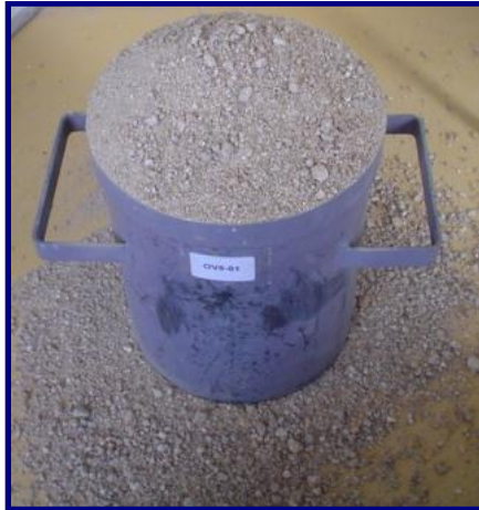
Figura 44. Olla sin enrasar de arena (agregados CEMEX).
