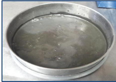
Figura 15. Muestra de arena en saturación por 24 horas
