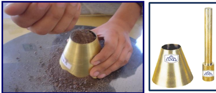
Figura 17. Llenado de cono truncado para determinar el SSS [34]
