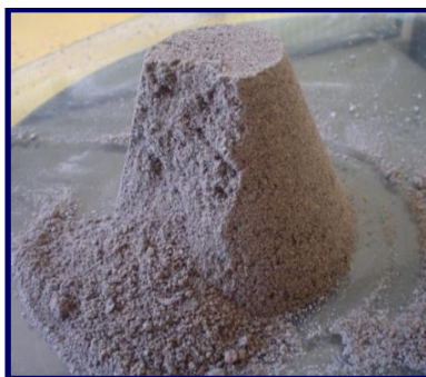
Figura 20. Muestra en SSS (agregados CEMEX).
