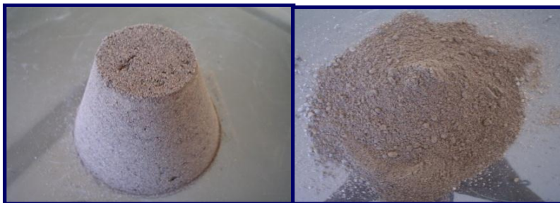
Figura 19. Muestra que no se encuentra en SSS (agregados CEMEX).
