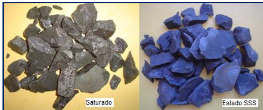
Figura 25. Comparación de una muestra saturada y una en estado SSS (agregados CEMEX).
