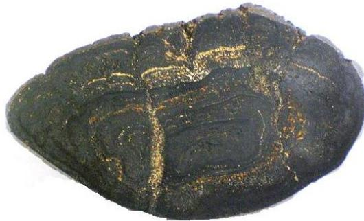
Figura 5.13. Alternancia en el color de las láminas (negro-ocre) que forman el nódulo polimetálico, colectado en la estación 13.
