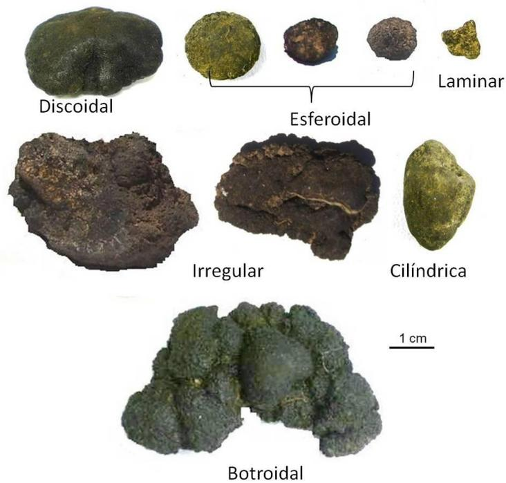
Figura 4.13. Principales formas en nódulos polimetálicos. Modificada de Cabrera *et al.* (en prensa).
