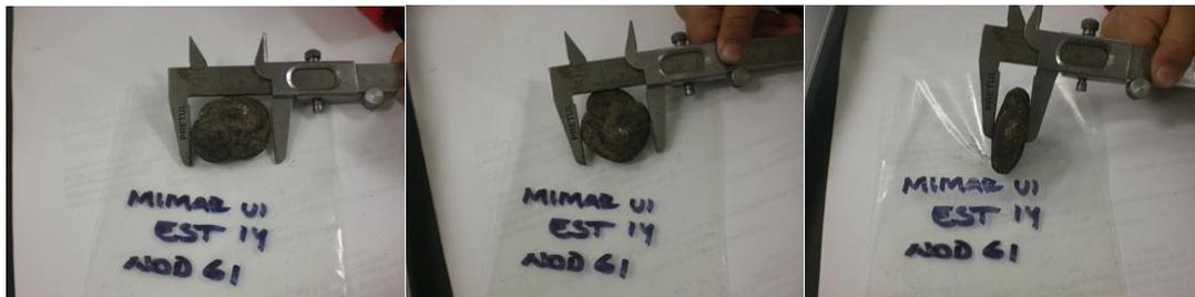
Figura 4.9. Obtención de la forma, mediante la medición de los tres ejes principales.
