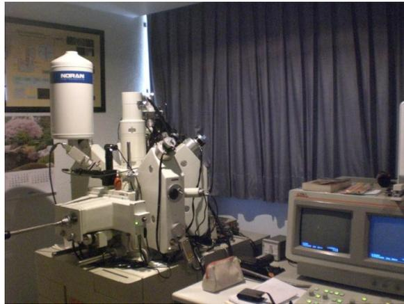
Figura 3.13. Microsonda electrónica del Laboratorio Universitario de Petrología del Instituto de Geofísica de la UNAM.
