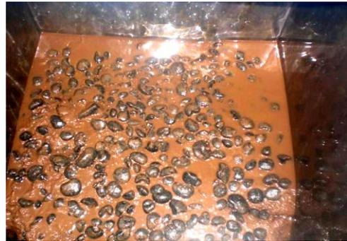
Figura 3.4. Ejemplos de nódulos polimetálicos colectados durante la Campaña MIMAR VI.
