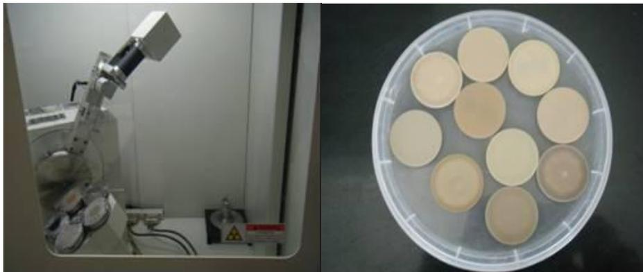
Figura 3.16. Equipo de DRX (izquierda) muestras para DRX (derecha).
