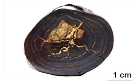
Figura 1.1. Nódulo polimetálico colectado durante la Campaña oceanográfica MIMAR VI, se observan las capas concéntricas alrededor del núcleo. Tomado de Cabrera *et al.* (en prensa)
