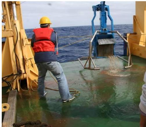
Figura 3.3. Recuperación de sedimentos mediante un nucleador de caja.
