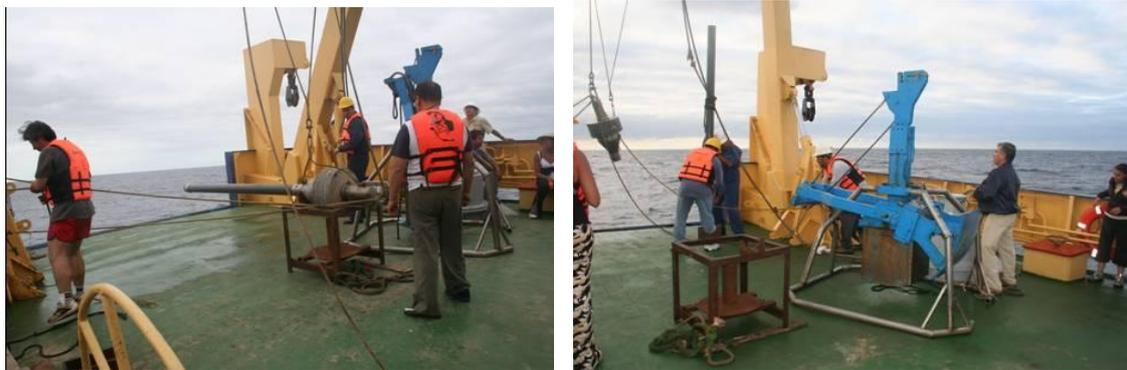
Figura 3.8. Recuperación de sedimentos mediante nucleador de gravedad.
