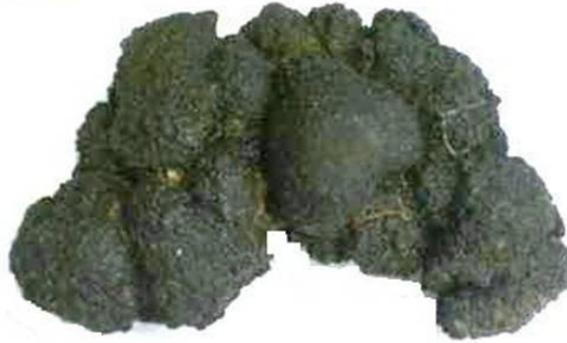
Figura 5.12. Textura botroidal relacionada con el crecimiento a partir de polinúcleos. Nódulo colectado en la estación 14.
