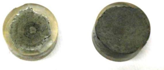
Figura 3.11. Superficies pulidas de nódulos polimetálicos.
