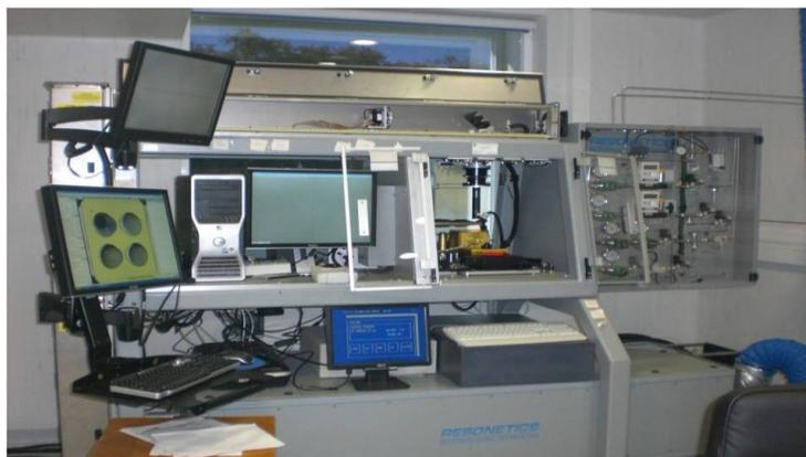
Figura 3.18. Equipo de ablación laser.
