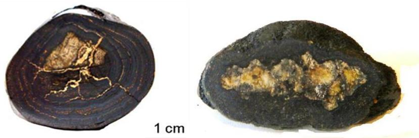
Figura 4.14. Núcleo de forma triangular (izquierda) e irregular (derecha).
