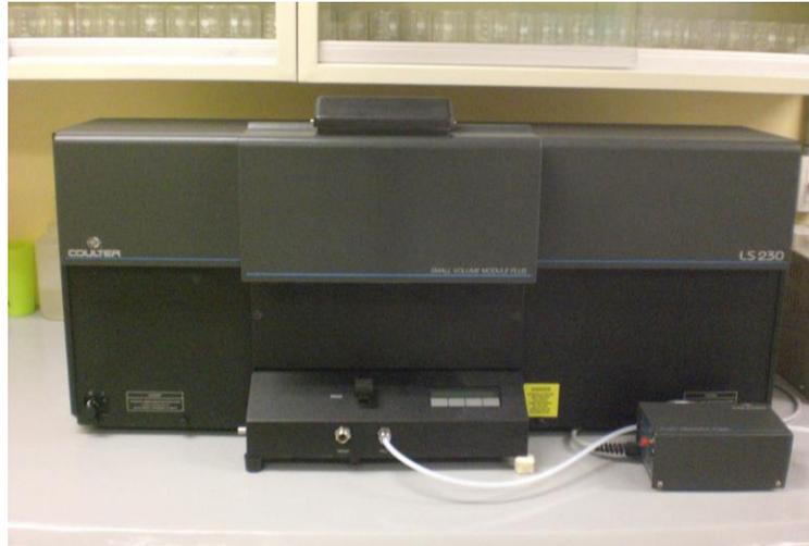
Figura 3.9. Analizador láser de partículas BeckmanCoulter modelo LS 230, del Laboratorio de Sedimentología del ICM yL de la UNAM.
