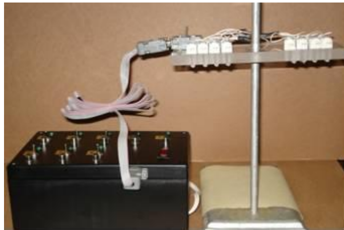
Figura 21. Circuito eléctrico y soporte de las válvulas solenoides del microdosificador.
