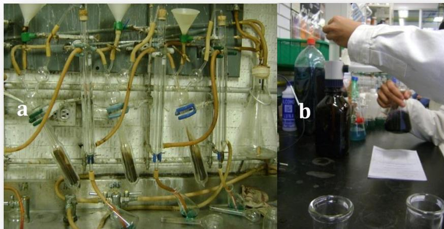
Figura 13. Determinación de a) nitrógeno total, b) materia orgánica.
