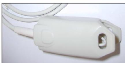
Figura 31. Sensor comercial dactilar.
