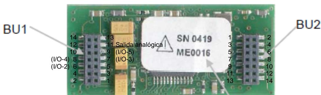
Figura 62. Pines de control del ChipOx para demultiplexado.
