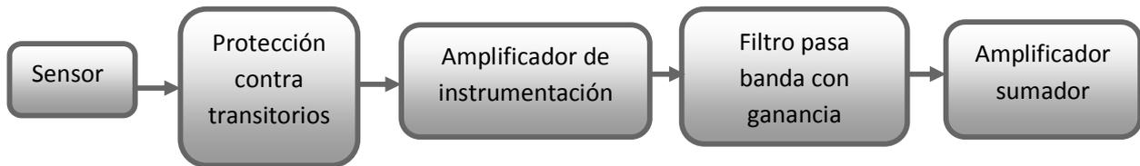
Figura 47. Etapas del circuito de acondicionamiento de señal.
