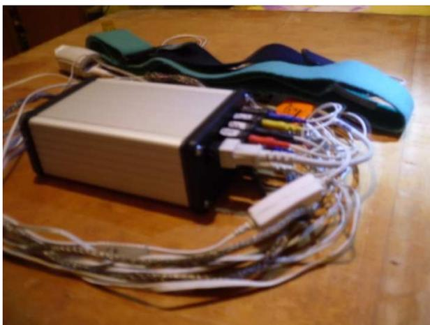
Figura 122. Prototipo desarrollado del sistema simplificado para estudios del sueño.
