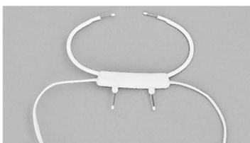
Figura 24. Sensor para frecuencia respiratoria bucal y nasal.
