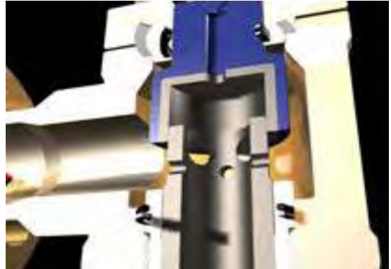
Fig. II. 6. Mecanismo Interno de un Estrangulador Submarino.
