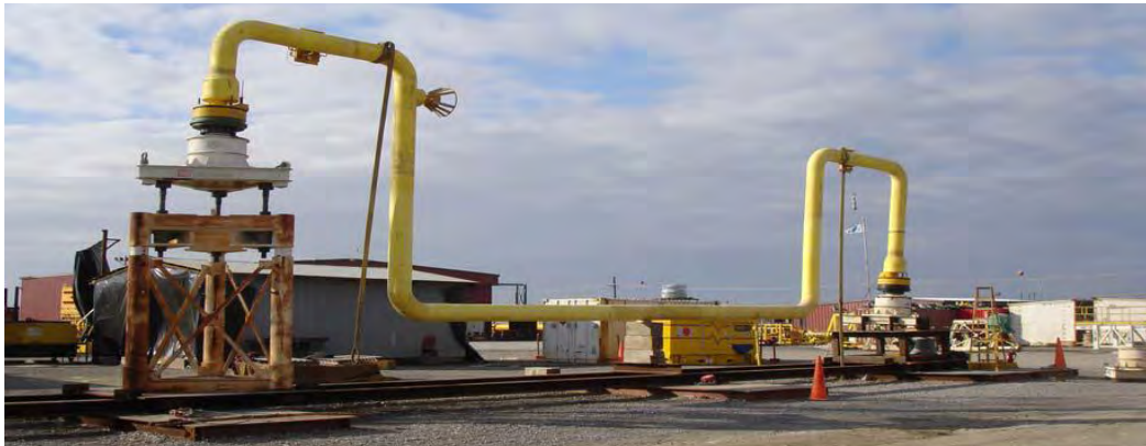
Fig. II. 23. Jumper rígido propiedad de Cameron.
