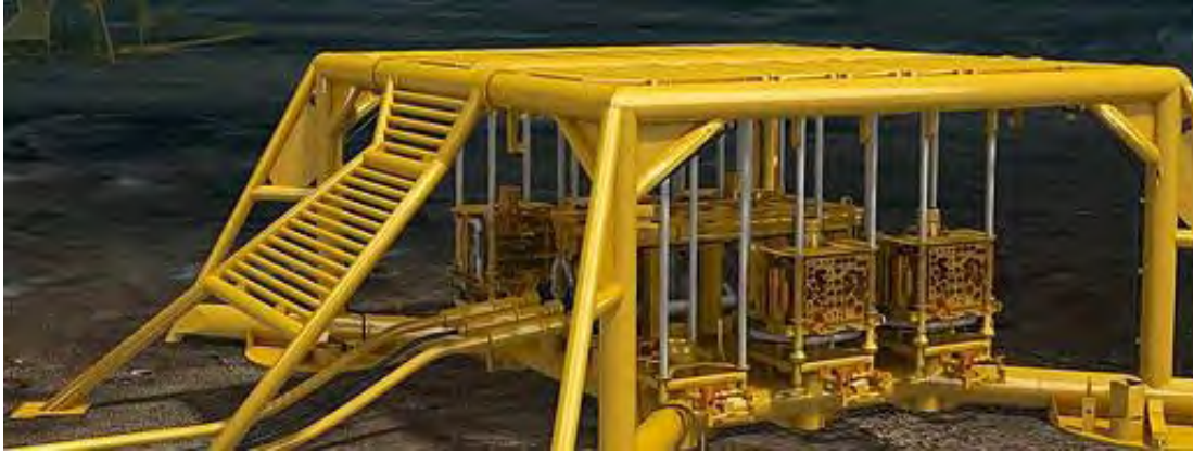
Fig. II. 21. Plantilla submarina propiedad de FMC Technologies.
