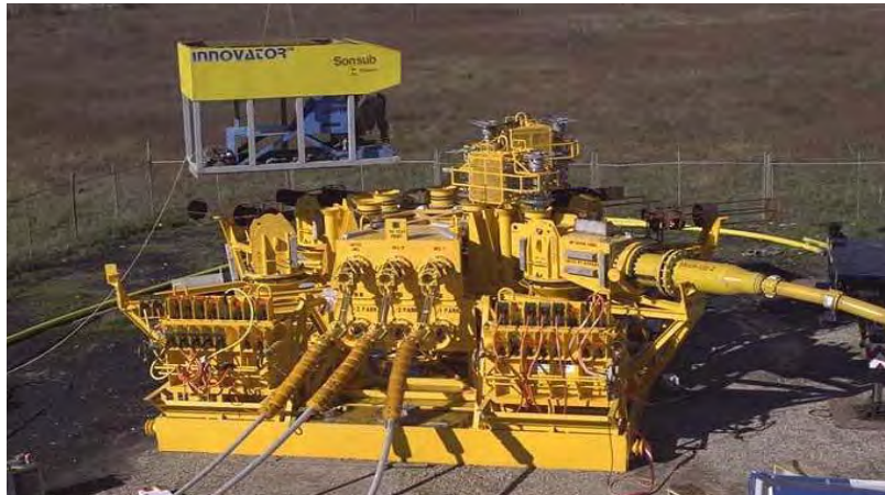
Fig. V. 19. Prueba en Sitio de una Unidad Hidráulica de Distribución y Conexiones del Umbilical y Cables de Conexión.
