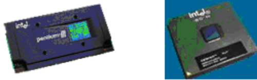
Figura I. 14 Microprocesador Pentium III para Slot 1 y para Socket 370
