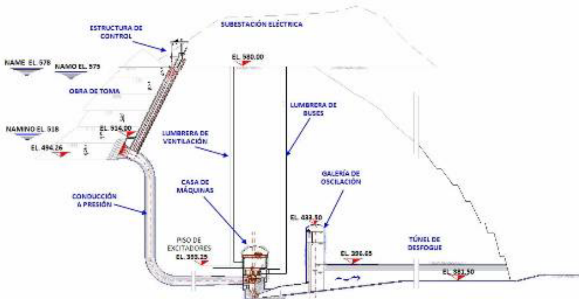
Figura 3.3 Obra de generación.
