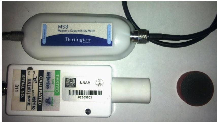
Figura 12. Susceptibilímetro y sensor para la medición de la concentración de minerales magnéticos en las muestras de los núcleos sedimentarios del paleolago Babícora.
