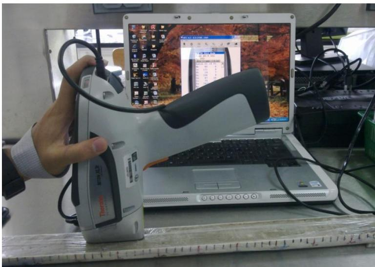
Figura 13. Medición de los núcleos sedimentarios con el equipo de Fluorescencia de Rayos X Niton XL3t.
