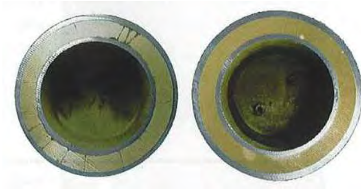
Fig. 24. El cemento normal de alta resistencia (izquierda) falla a los 4500 psi o en condiciones de presurización cíclica, mientras que el cemento espumoso resiste presiones de 9000 psi
