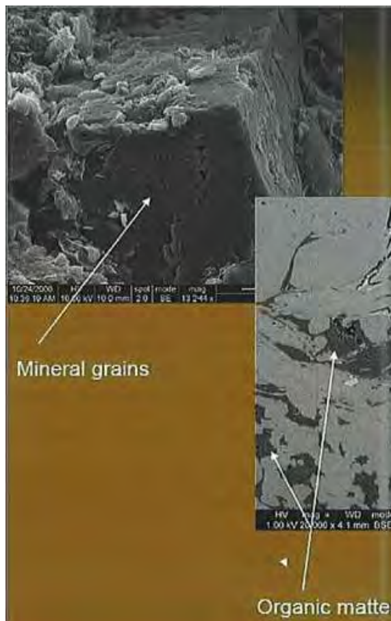
Fig. 6. Imágenes con microscopio electrónico de barrido mostrando la porosidad de los componentes (Rai et al. 2009).
