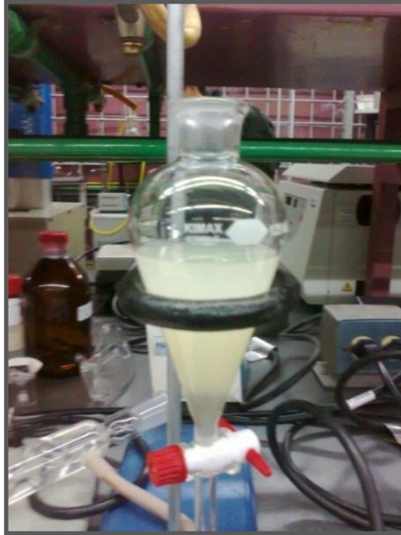
Figura 4.5 Embudo de separación con fases obtenidas de la reacción.
