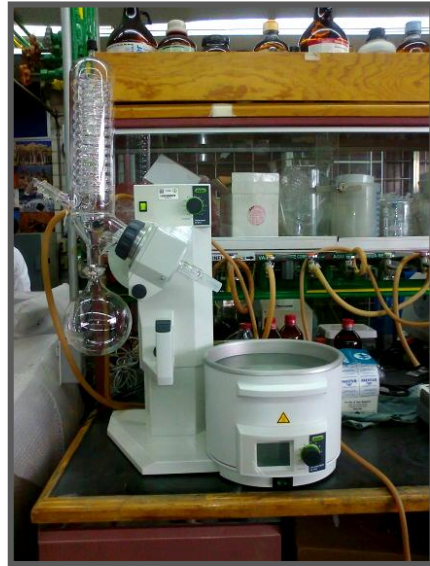
Figura 4.6 Rotavapor Buchi R-210 usado durante la experimentación
