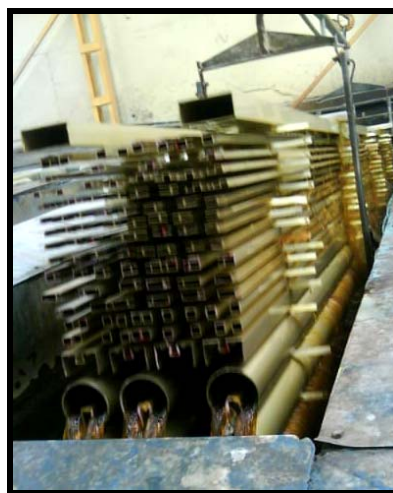
Figura 4.8 Carga de perfiles a la salida del baño de cromatizado.
