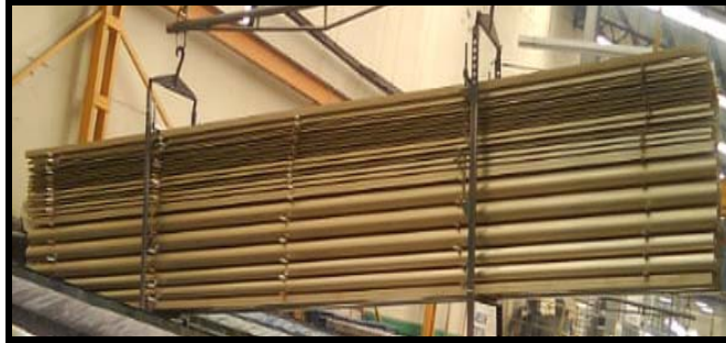
Figura 4.9 Carga de perfiles de aluminio despues del baño cromo se aprecia el color dorado caracteristico del cromatizado.
