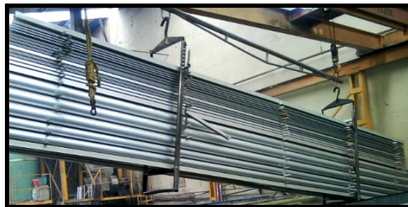
Figura 4.1 Carga de perfiles de aluminio listos para entrar a la fase de decapado.
