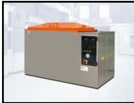
Figura 7.1 Cámara de niebla salina. [12]
