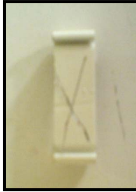
Figura 7.5 Trozo de perfil despues del test machu.
