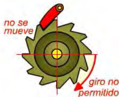
FIGURA 55. Sistema de trinquete (33)
