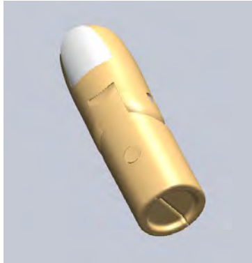
FIGURA 62. Vista inferior. Espacio para el muñón, en SolidWorks
