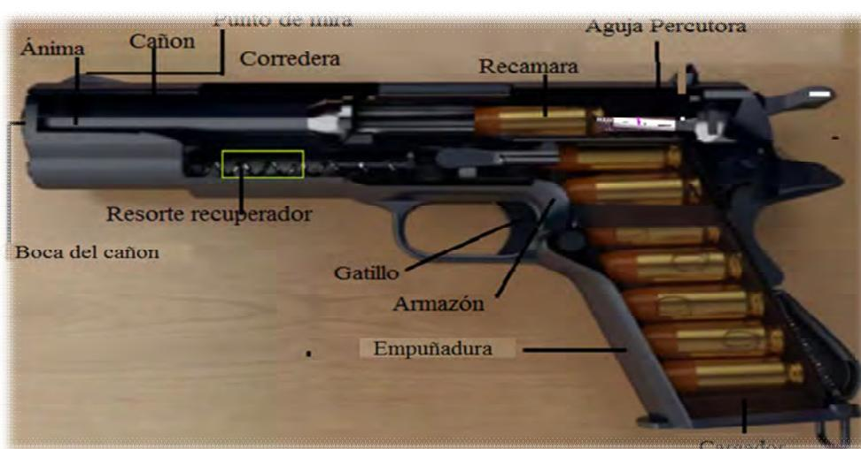
Figura 3.8. Partes principales de un arma de fuego semiautomática.
