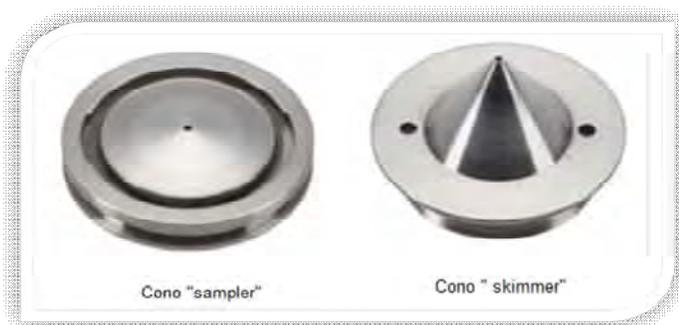
**Figura 5.4. Conos de níquel “sampler” y “skimmer”.**
