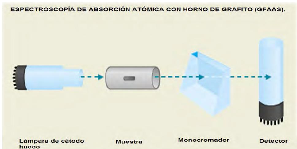
Figura 4.1. Esquema de los constituyentes de un equipo GFAAS.
