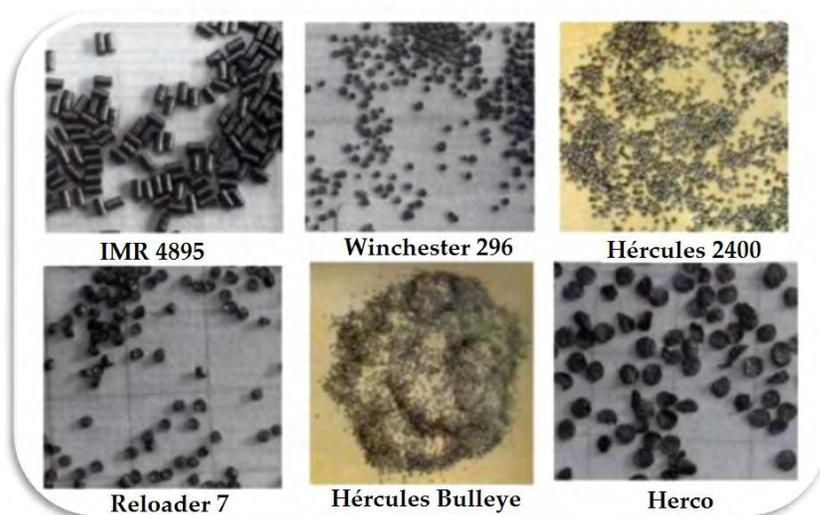
**Figura 3.17** Diversas estructuras de propelente, la velocidad de quemado se regula con el granulado, cuanto más grueso el granulo es más lenta la combustión.
