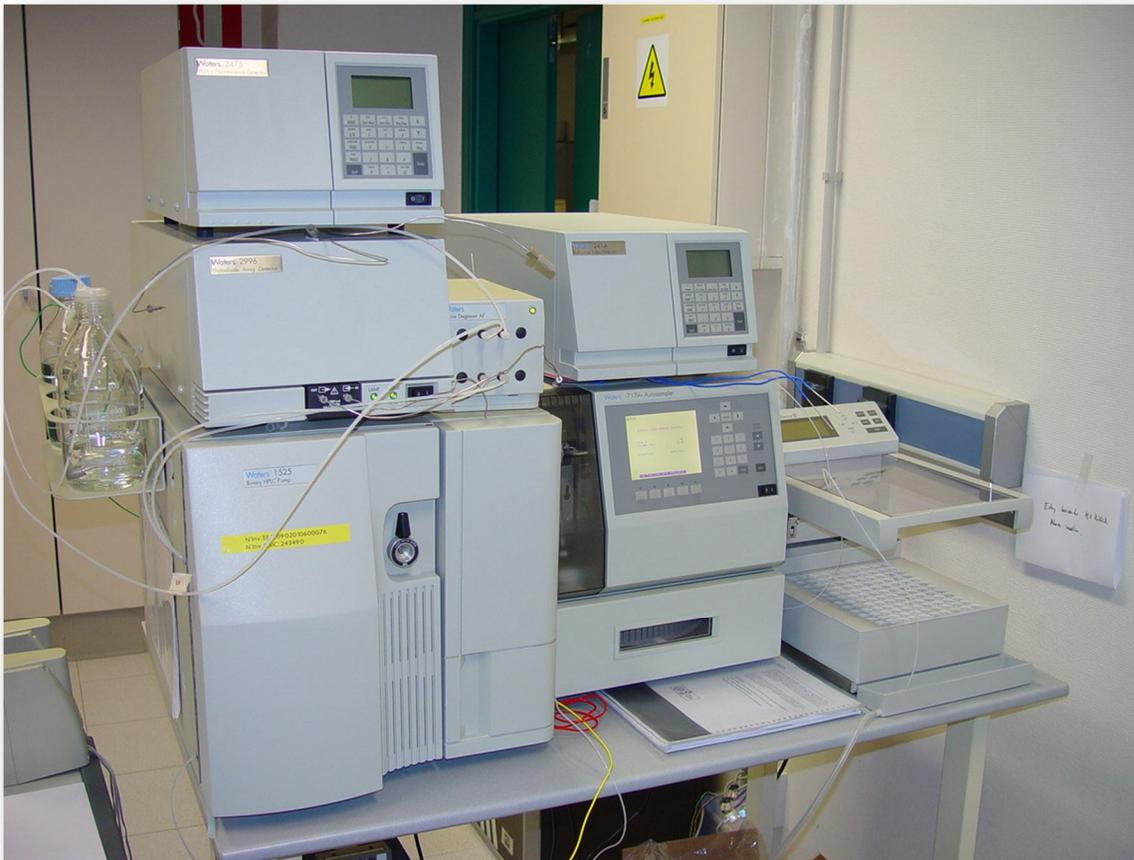
Figura 27. Cromatógrafo líquido de alta resolución (HPLC).<sup>75</sup>
