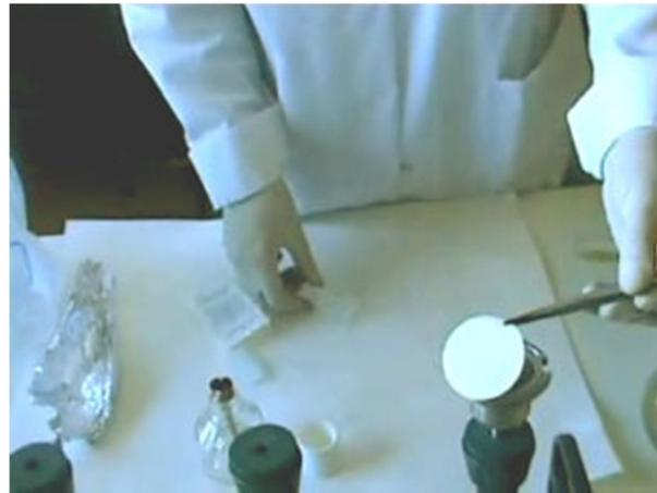
Se coloca un embudo de filtración estéril, para evitar contaminación de la proteína.
