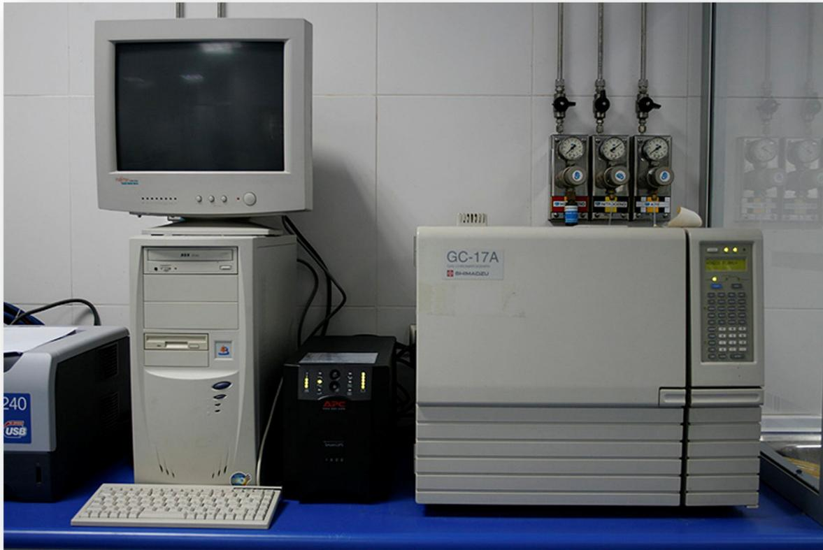
Figura 28. Cromatógrafo de gases.<sup>76</sup>
