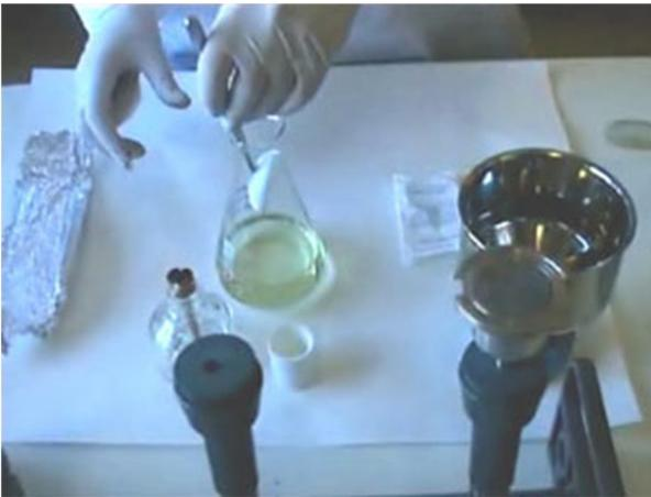
Terminando la filtración, se traspara el sobrenadante a tubos eppendorf para comenzar la centrifugación del producto.
