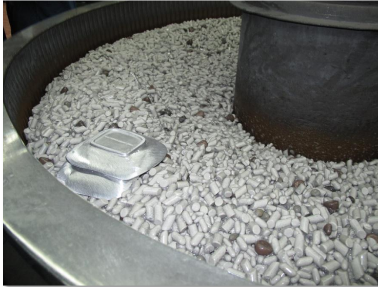
Figura 19. Pulido mecánico en tina de vibrado.
