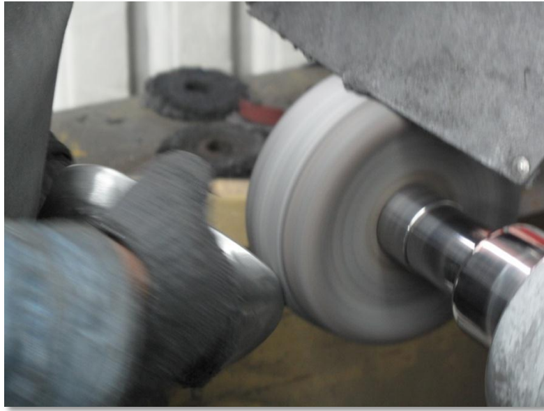
Figura 26. Pulido desvanecedor de rayas gruesas en ambas partes de la pieza después del pulido con el primer esmeril.
