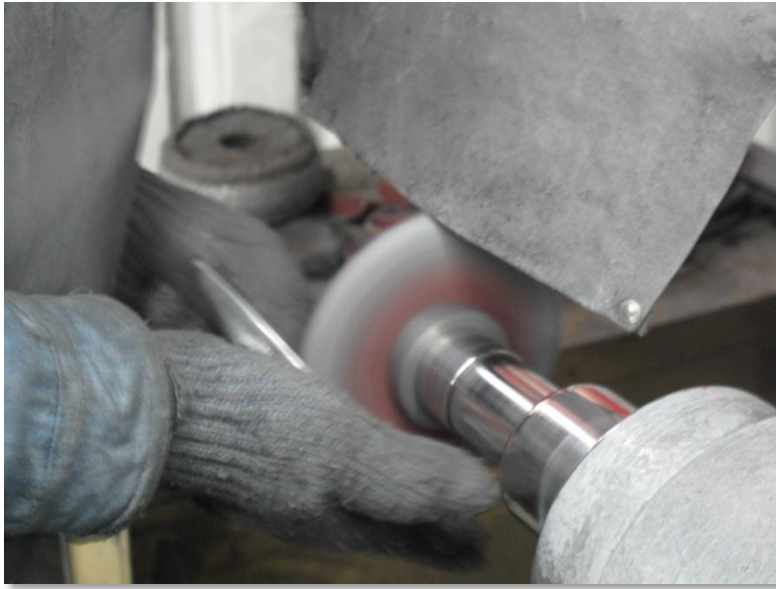
Figura 32. Pulido desvanecedor que afina las posibles rayas gruesas, en ambas partes de la pieza.
