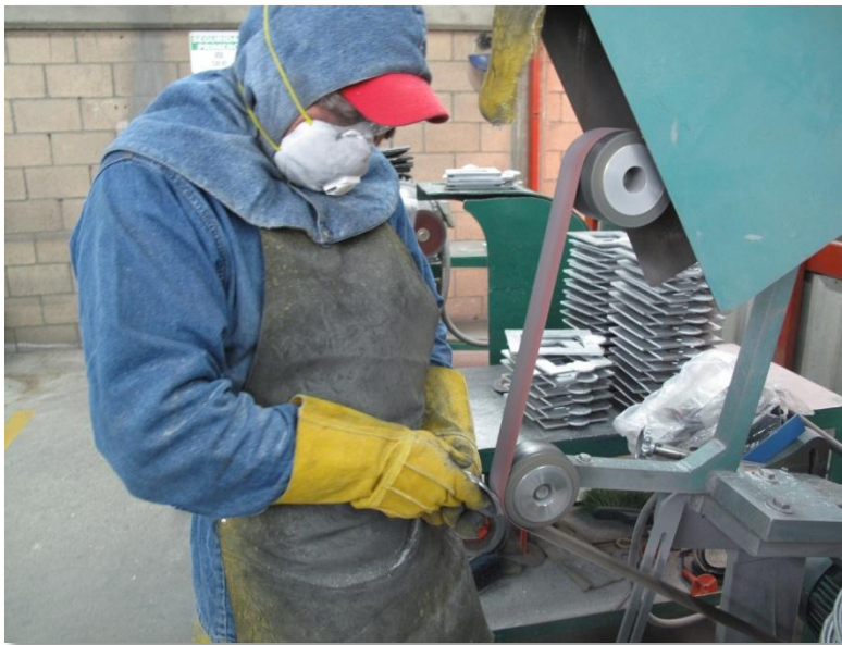
Figura 14. Arreglo de las imperfechos derivadas de fundición.
