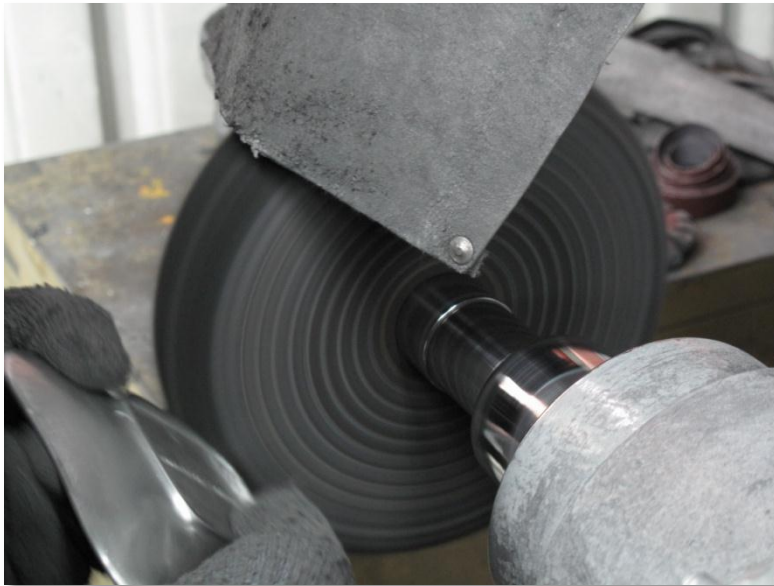
Figura 34. Abrillantado de la parte externa de las piezas con un sisal grande.
