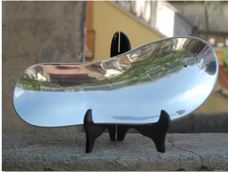
Figura 49. “Sandalia” fabricada con una aleación 356.2MA con 0.2% de Ni y una relación Fe/Cu 1:2.
