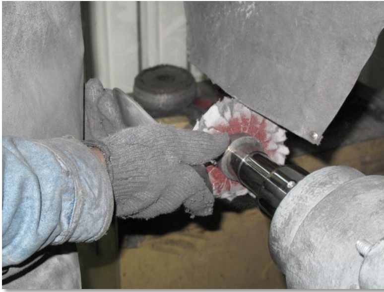
Figura 44. Vista del pulido con las lijas incorporadas en la rueda de manta.
