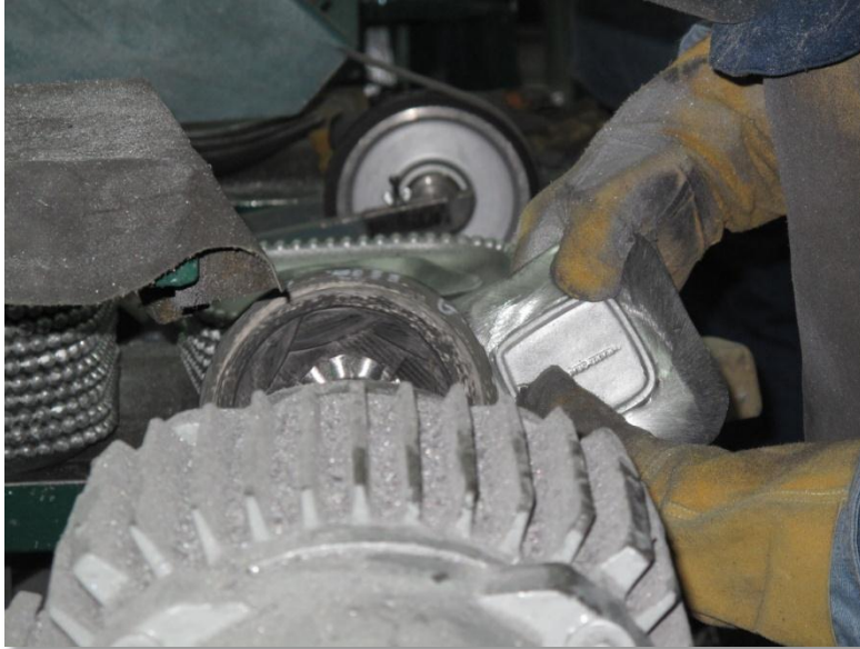
Figura 15. Lijado externo de la pieza.
