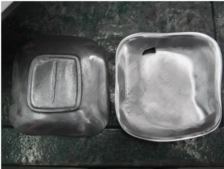
Figura 33. Piezas pulidas con una lija de grano 400 de \text{Al}_2\text{O}_3 (en ambas partes pieza) que muestran una raya más fina y un mejor acabado de la pieza.
