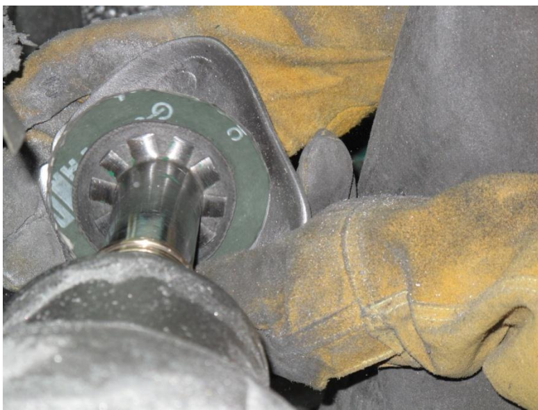
Figura 16. Lijado externo de la pieza.
