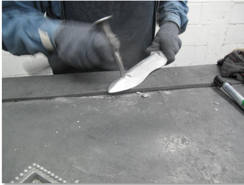
Figura 22. Sellado de cavidades con piedras de escoria.
