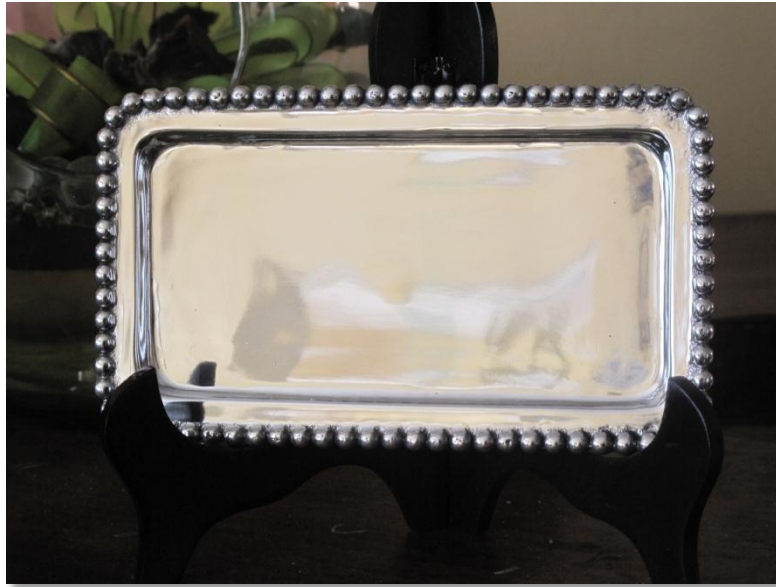
Figura 51. Joyero fabricado con una aleación 356.2MA modificada para que contuviera 0.26% de Ni y una relación Fe/Cu 1:2.
