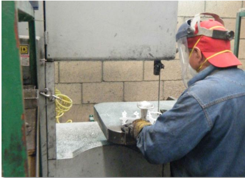
Figura 13. Corte de corretores, alimentadores y bajadas de las piezas de aluminio fabricadas.
