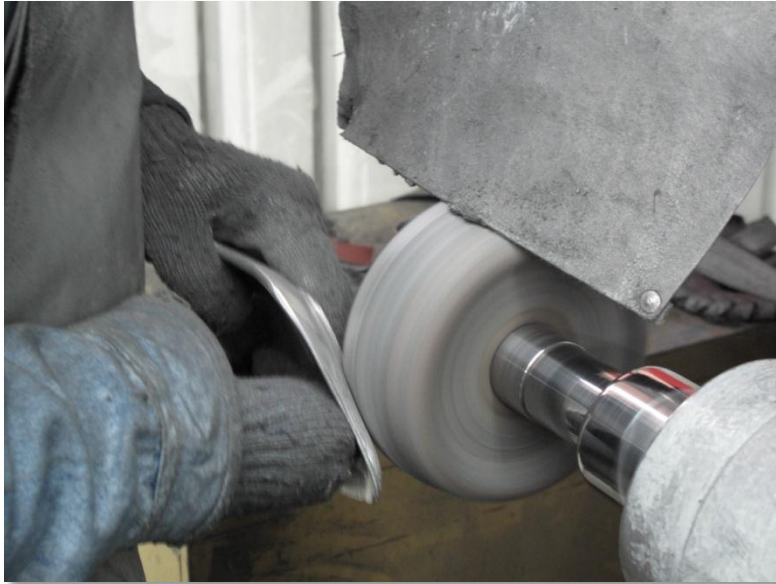
Figura 25. Pulido desvanecedor de rayas gruesas en ambas partes de la pieza artesanal después del pre-acabado.
