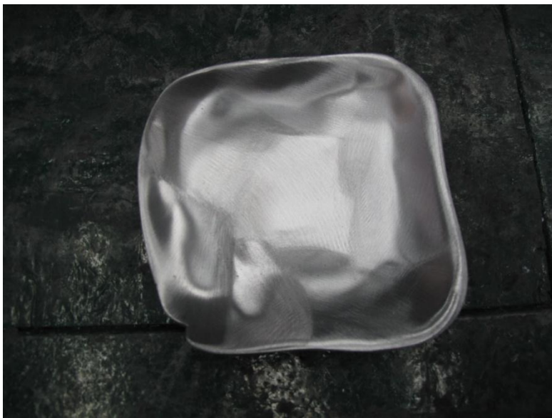
Figura 29. Pieza pulida con lija grano 100 de Al_2O_3 (en ambas partes pieza artesanal ) para desvanecer rayas gruesas ocasionadas en el pre-acabado.
