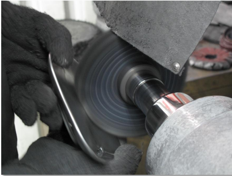
Figura 35. Abrillantado de la parte interna de las piezas con un sisal pequeño.
