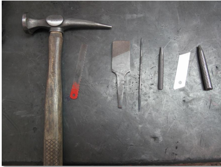
Figura 20. Herramental utilizado para reparar poros en piezas artesanales.
