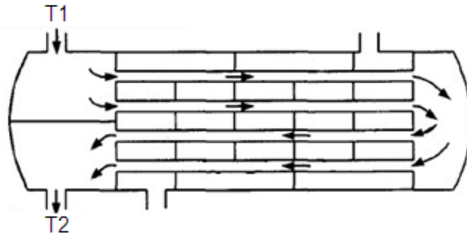
Figura 1.3. Ruta seguida por el del fluido que se desplaza por tubos en un intercambiador.
