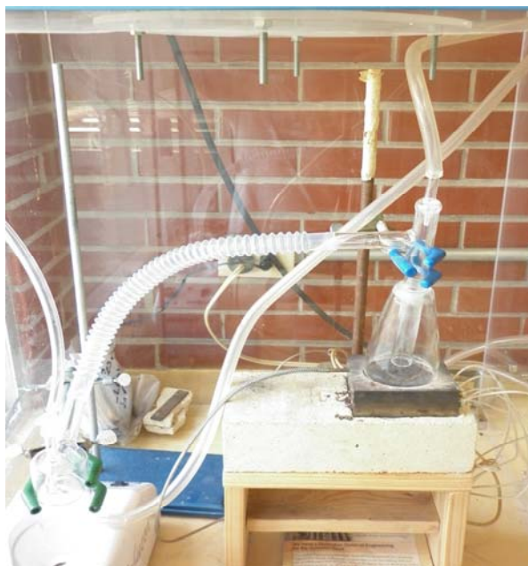
Figura 10. Sistema de rocío pirolítico usado en el laboratorio.
