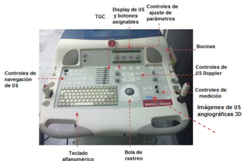
Figura 50. Teclado y controles del panel principal de ultrasonido del sistema de neuronavegación SonoWand®.
