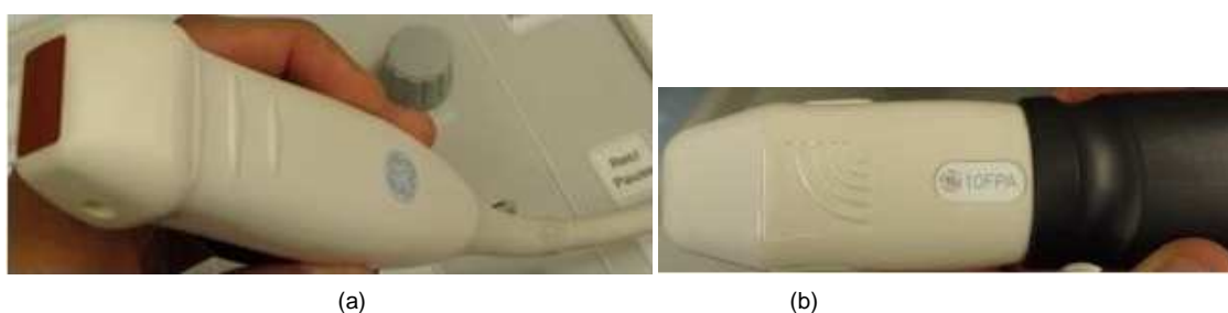
Figura 9. Transductores de ultrasonido. (a) 5MHz. (b) 10MHz del sistema SonoWand® 1.4.
