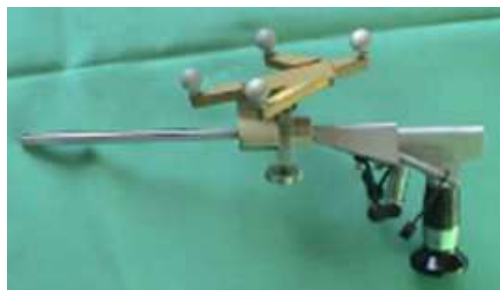
Figura 18. Localizador de propósito general montado a un endoscopio.
