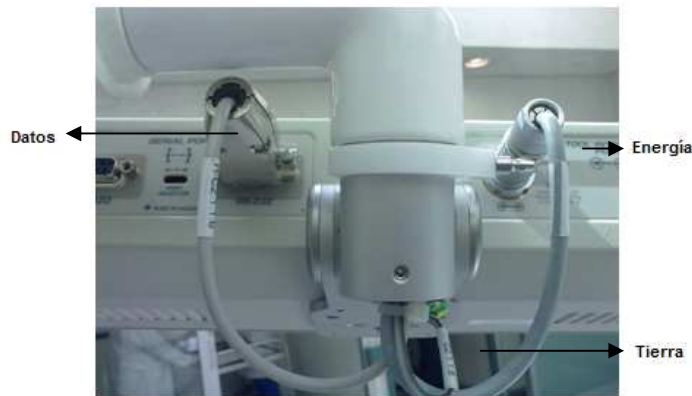
Figura 77. Conexión de los cables de datos, energía y tierra hacia la unidad de rastreo óptico del sistema.
