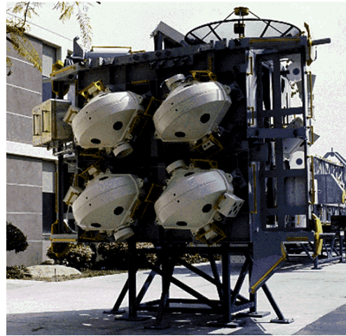
Figura 1.20 Ejemplo de giroscopio de control de momentos 28
