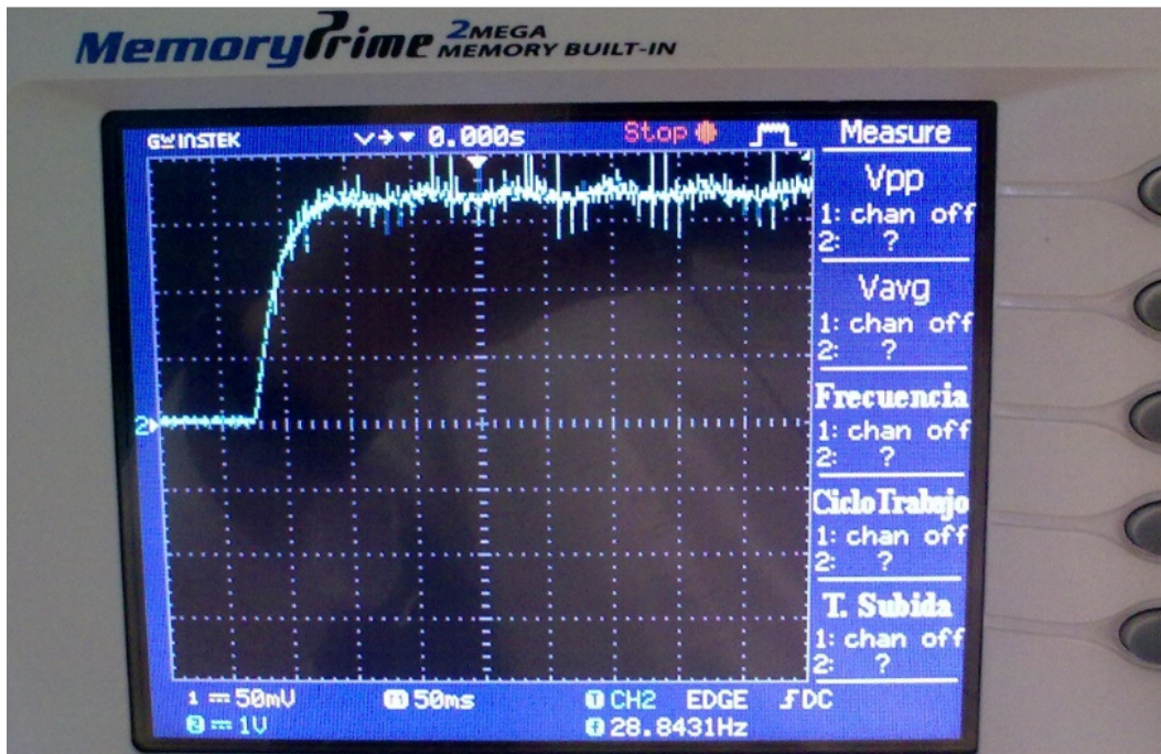
Figura B4.2 Experimento de la Prueba de Respuesta Escalón
