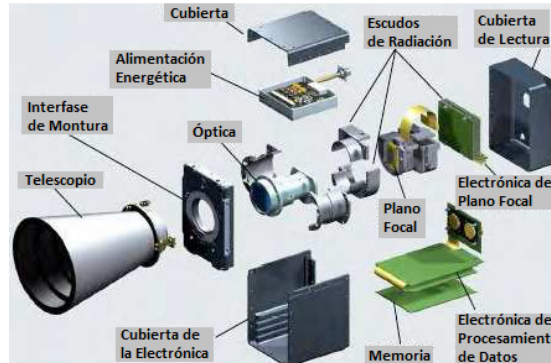
Figura 1.17 Esquema de un sensor de estrellas
