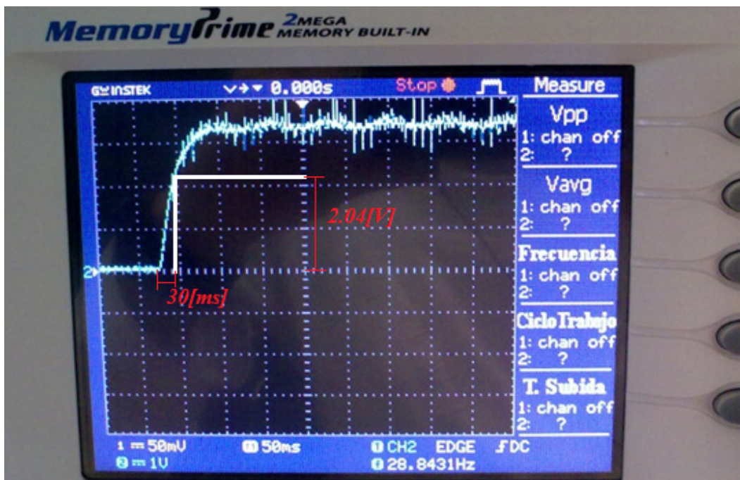
Figura B4.3 Experimento de la Prueba de Respuesta Escalón con señalización de Valores
