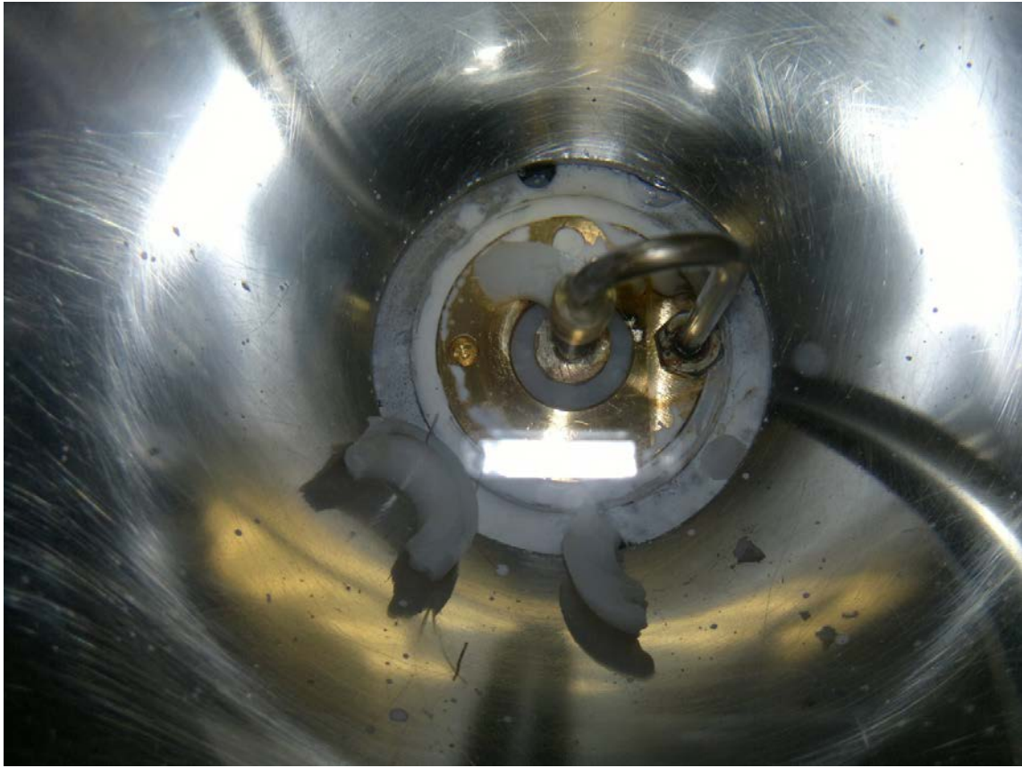
Figura 3. 1 Fotografía de la ruptura de la base de la bujía, vista desde la parte superior de la misma.
