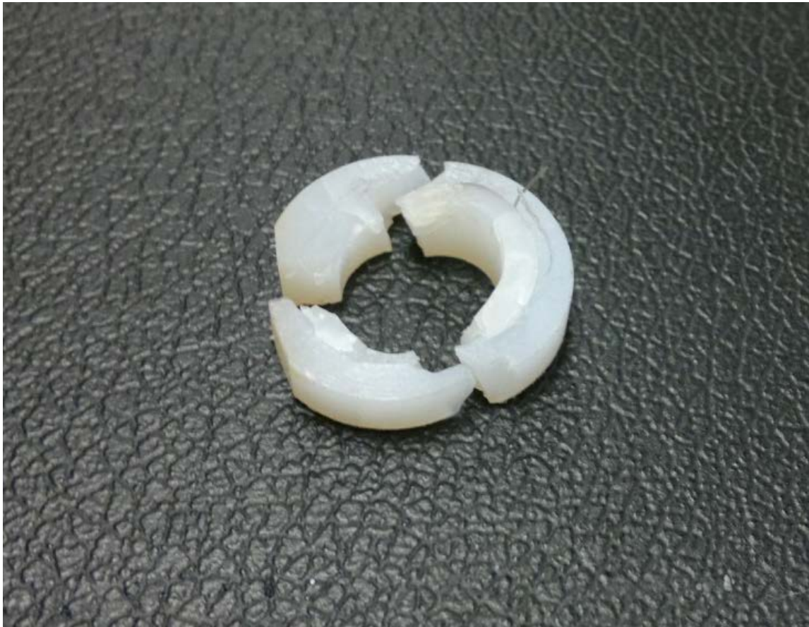
Figura 3. 2 Fotografía de los fragmentos de la base de la bujía.
