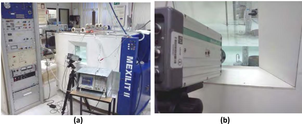
**Figura II.2: Fotografías del montaje experimental. (a) Vista general. (b) Acercamiento de la videocámara frente a la bujía del generador.**
