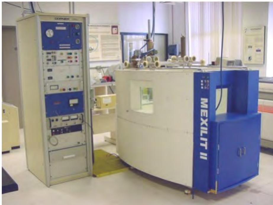
**Figura 1.13: Generador de ondas de choque de tipo electrohidráulico, Mexilit II.**
