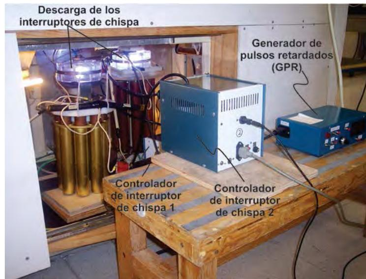
**Figura II.11: Instante de la activación de los interruptores de chispa.**
