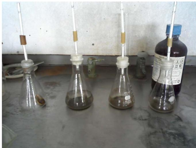
Figura 7-4. Sistema para determinación de carbono inorgánico con trampa para humedad.
