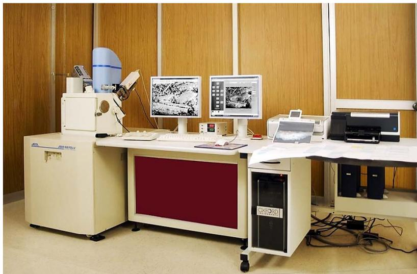
Figura 7-3. Microscopio electrónico de alto-bajo vacío y fluorescencia de rayos-X JSM 6610 LV (ININ 2011)
