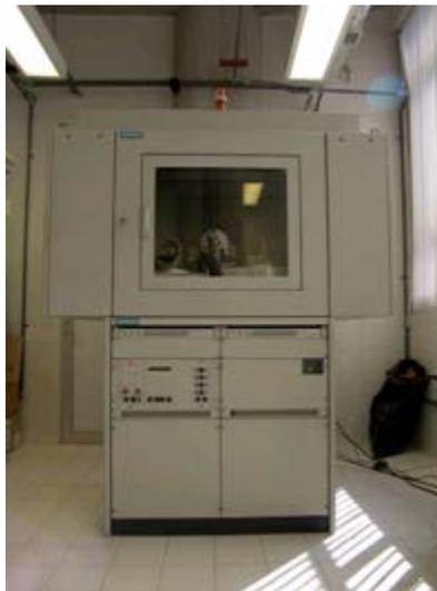
Figura 7-2. Difractómetro de rayos X para polvos Siemens D500. (USAI. UNAM 2011).
