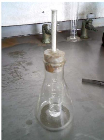
Figura 7-5. Vial con HCl para eliminación de  $\text{CO}_2$ .
