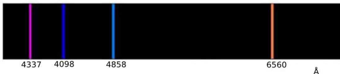
Figura 25 El hidrógeno emite, dentro del visible, en una cierta longitud de onda del naranja, en otra del azul, otra del añil y otra del violeta.
