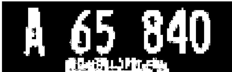
Imagen 6-63 SM binarizada con remoción de estructuras con área por debajo del discriminante.
