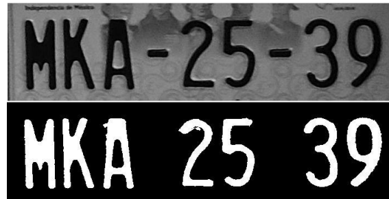
Imagen 6-53 SM a escala de grises y binarizada de la placa más cercana.
