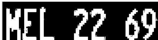
Imagen 6-70 SM binarizada con remoción de estructuras con área por debajo del discriminante.
