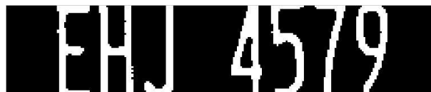
Imagen 6-5 SM binarizado con remoción de estructuras con áreas por debajo del discriminante.
