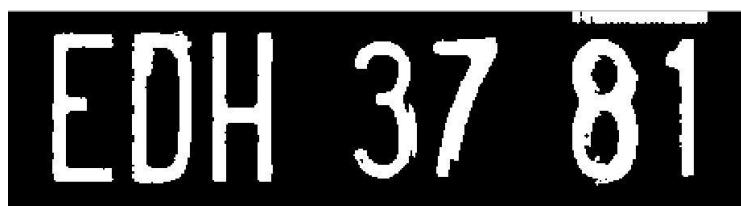
Imagen 6-75 SM binarizada con remoción de estructuras con área por debajo del discriminante.
