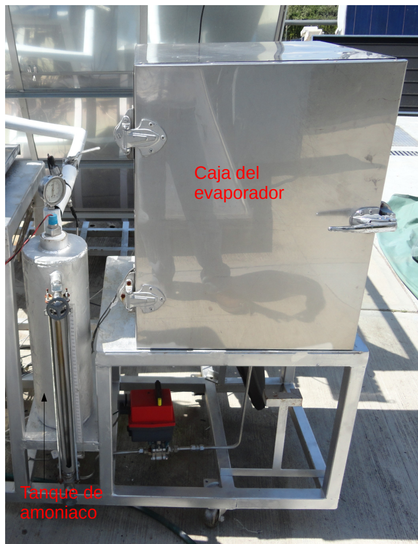
Fig. 3.4: Tanque de \text{NH}_3 condensado y evaporador
