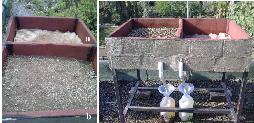
Figura 10. Modelo a escala ubicado en la azotea verde estudiada. A la derecha (a), modelo con material de soporte y (b) con material y sustrato. Izquierda, modelo escala, tubería PVC y envases de captura de agua infiltrada para el análisis de metales pesados.
