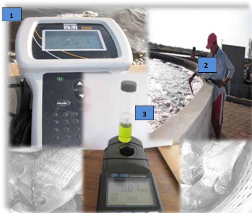
**Figura 2.- Instrumentos con los que se mide la calidad del agua:
