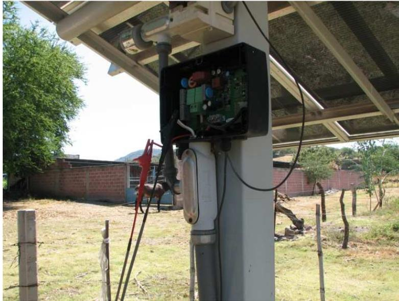
Figura No. 3- 18 Conexión del trazador de curvas con el arreglo fotovoltaico El Amate.
