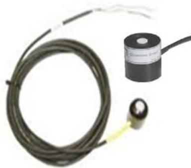
Figura No. 3- 3 Sensor fotoeléctrico Li-cor.
