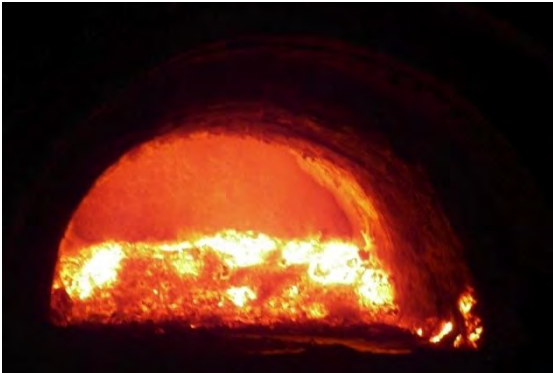
Figura 3.7. Escoria sobrecalentada dentro del horno .
