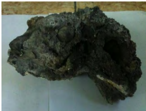
Figura 3.2. "Turrón" de escoria sobrecalentada.
