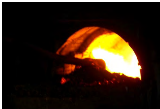
Figura 3.9. Escoriado manteniendo la apertura de los quemadores con alta intensidad.
