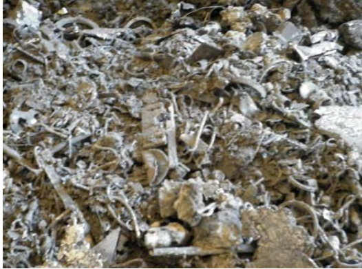
Figura 3.5. Escoria con alto contenido ferroso.
