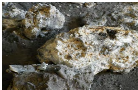
Figura 3.3. Escoria con alto grado de sobrecalentamiento.
