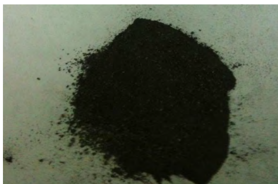
Figura 3.4. Escoria granular "seca".
