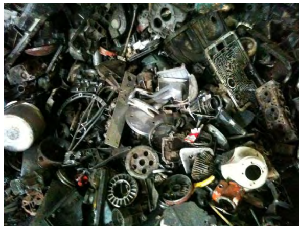
Figura 1.4 Materia prima que presenta una relación \frac{\text{Área}_{\text{superficial}}}{\text{masa}} < 1 , denominada "macizo".
