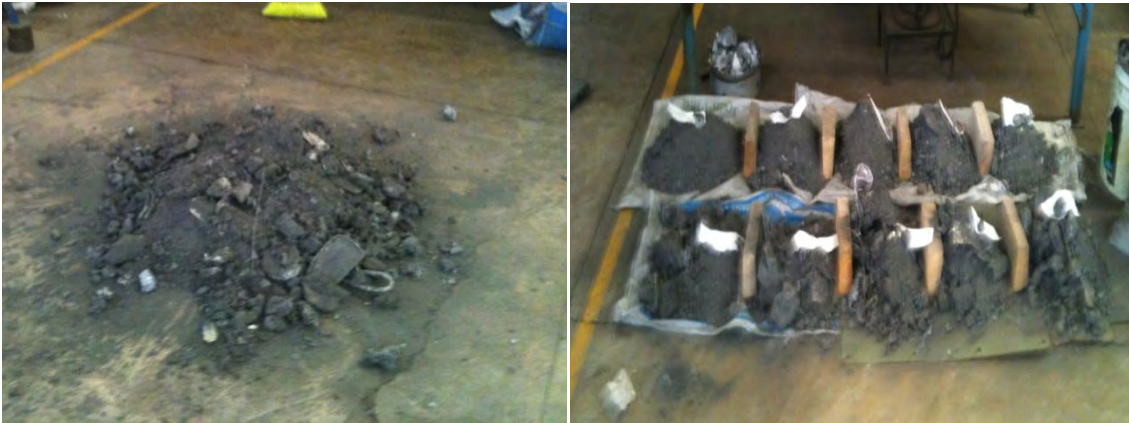
Figura 3.10 Adquisición de muestras representativas de escoria. Al frente están las muestras en obtenidas de fusiones sin fundente, atrás las muestras obtenidas de fusiones con fundente.
