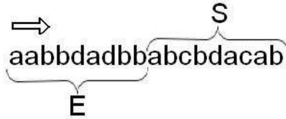
Figura 2.7: Ejemplo de una secuencia siendo codificada por el algoritmo *LZ77*
