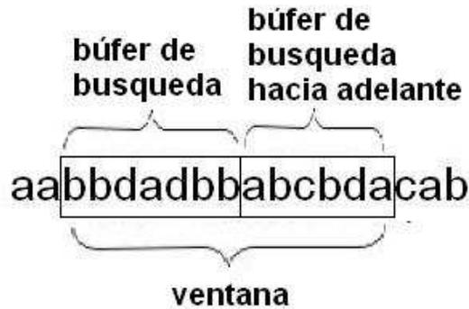
Figura 2.8: Principio *sliding window*
